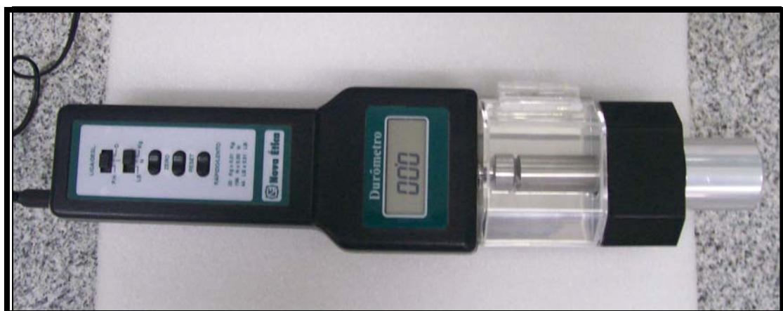
Figura 5 – Durômetro utilizado na equivalência farmacêutica de comprimidos de Captopril e Cloridrato de Propranolol.
