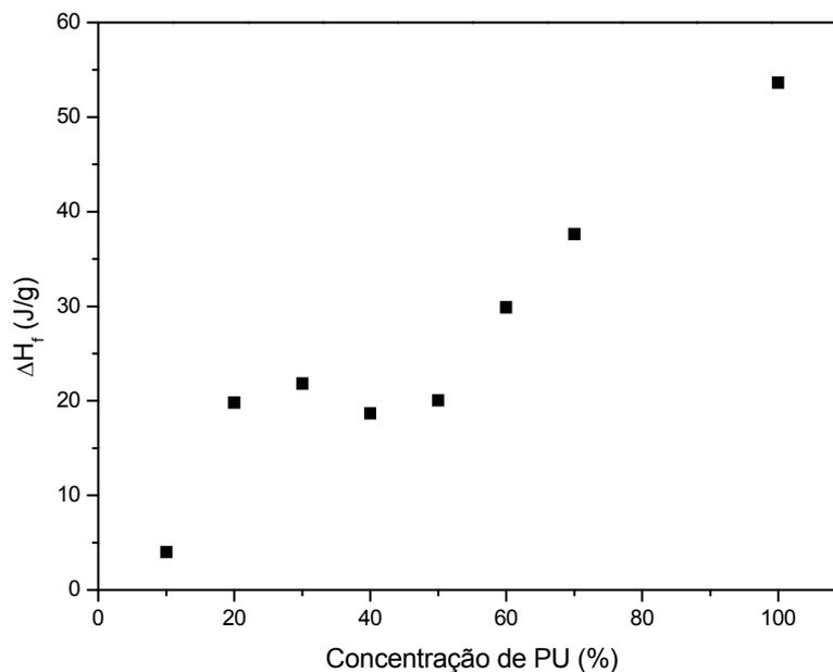
Figura 30 – Entalpia de fusão ( $\Delta H_f$ ) da fase cristalina do PU em função da concentração deste nas blendas.
