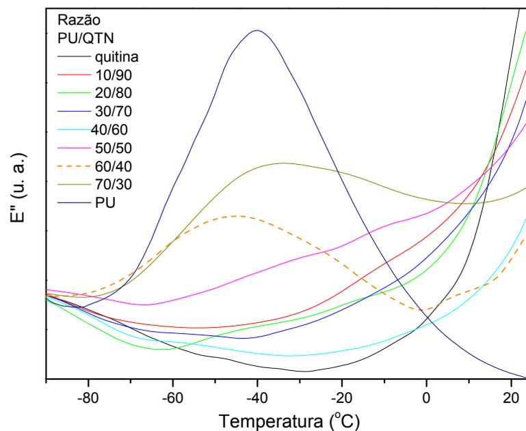
Figura 38 – Módulo de perda ( $E''$ ) para as blendas PU/QTN.
