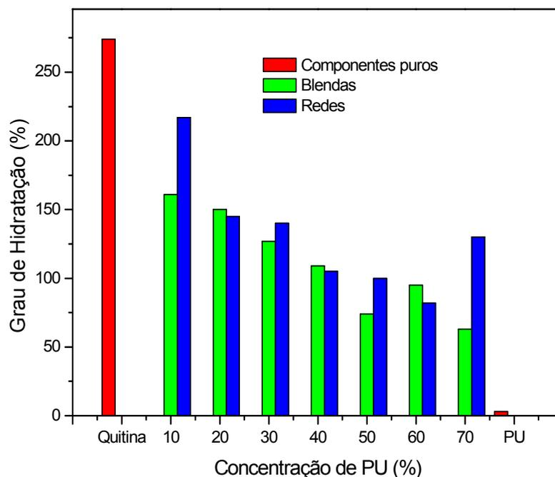
Figura 51 - Grau de hidratação dos filmes em função da concentração de PU.
