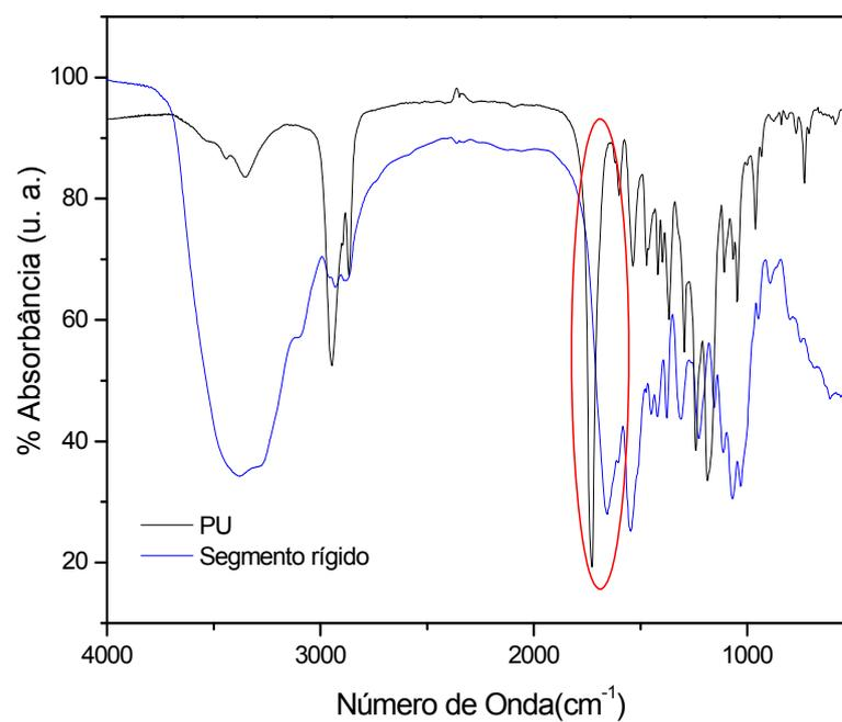
Figura 19 – Espectros de IV do PU e da rede modelo.
