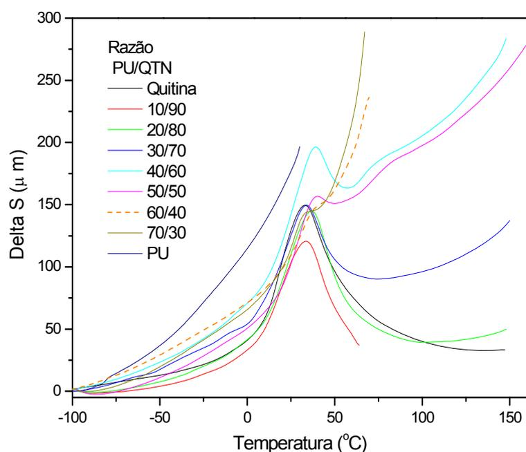
Figura 43 – Delta S em função da temperatura para as redes PU/QTN.
