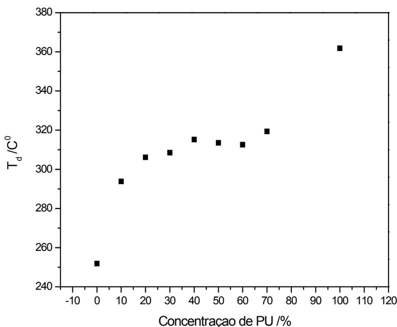
Figura 22 –  $T_d$  em função da concentração de PU presente nas blendas.
