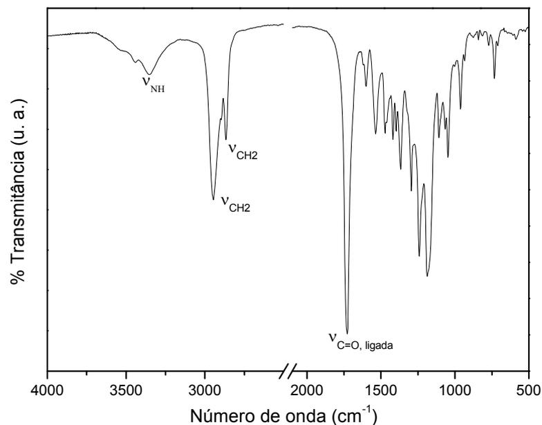
Figura 15 – Espectro de IV do filme de PU.
