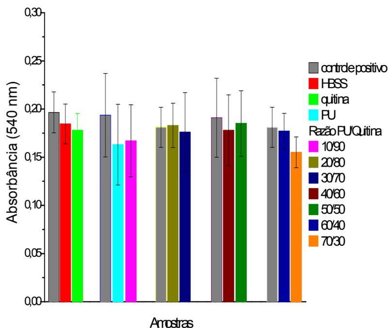
Figura 53 – Resultados dos ensaios de citotoxicidade direta das soluções de HBSS puro e das submetidas no ensaio de degradação dos filmes PU e quitina puros e das redes 10/90, 20/80, 30/70, 40/60, 50/50, 60/40 e 70/30.
