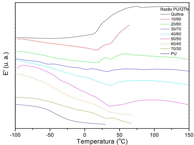
Figura 45 – Módulo de armazenamento ( $E'$ ) para as redes PU/QTN.
