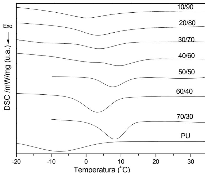
Figura 28 – Curvas de DSC para os polímeros puros e para as blendas PU/QTN, ao resfriamento.
