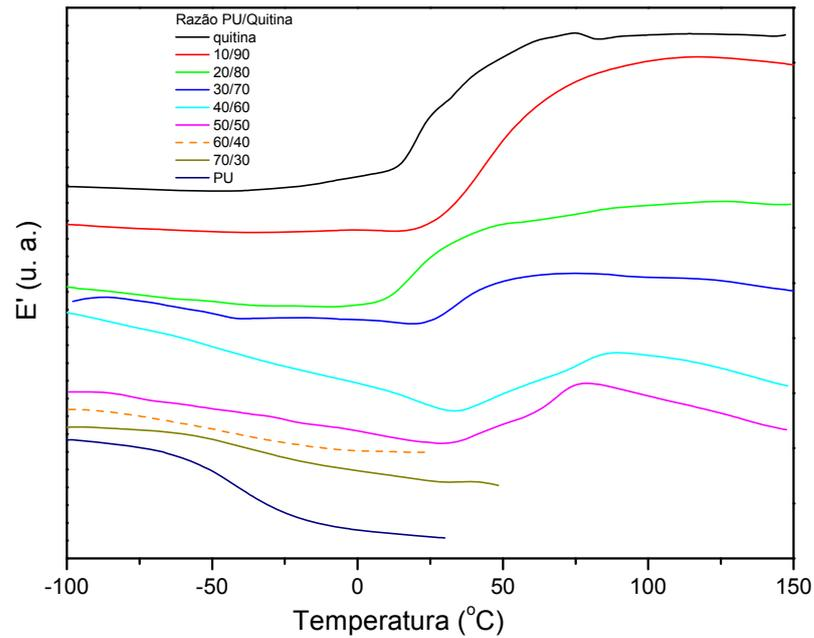
Figura 44 – Módulo de armazenamento ( $E'$ ) para as blendas PU/QTN.
