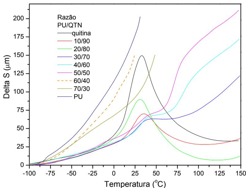
Figura 42 – Delta S em função da temperatura para as blendas PU/QTN.
