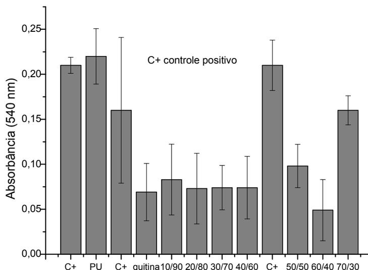
Figura 54 – Resultados do ensaio de adesão das células Vero após 48 horas de contato com os componentes puros (PU e quitina) e das redes 10/90, 20/80, 30/70, 40/60, 50/50, 60/40 e 70/30.
