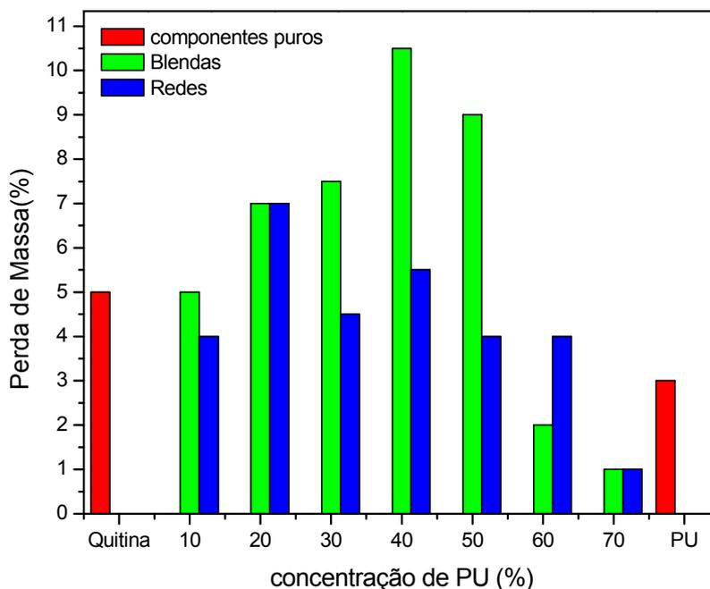
Figura 52 - Porcentagem de perda de massa no ensaio de degradação.
