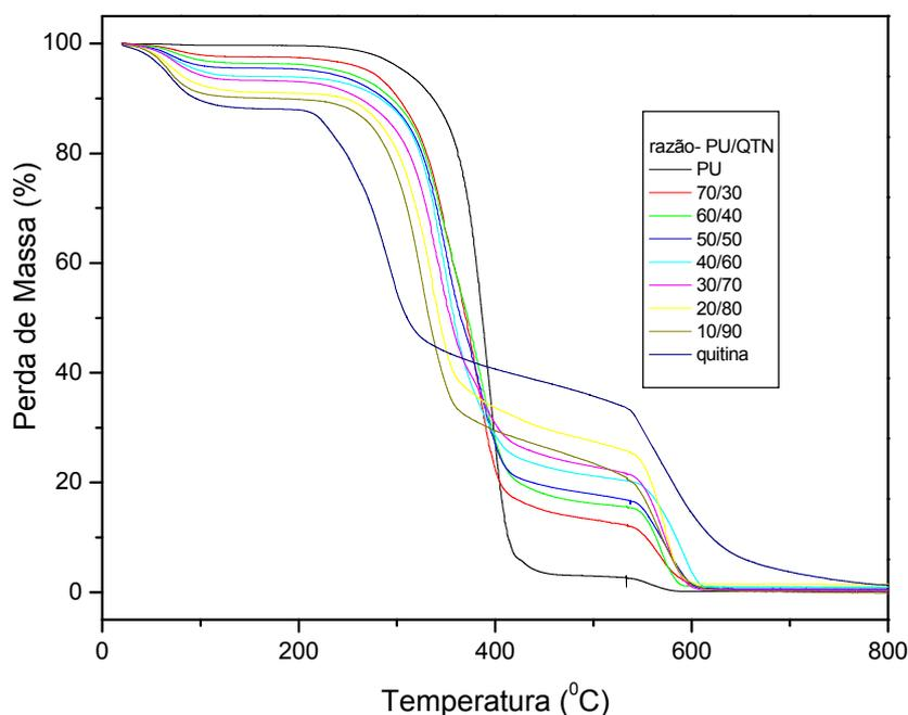
Figura 20 – Curvas termogravimétricas em várias composições das blendas de PU/QTN e dos polímeros puros.
