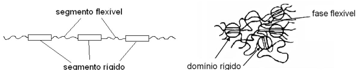
Figura 09 – representação esquemática da separação de fases em poliuretanos segmentados.
