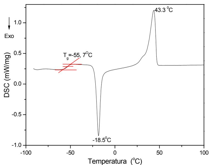
Figura 26 – Curva de DSC do PU.
