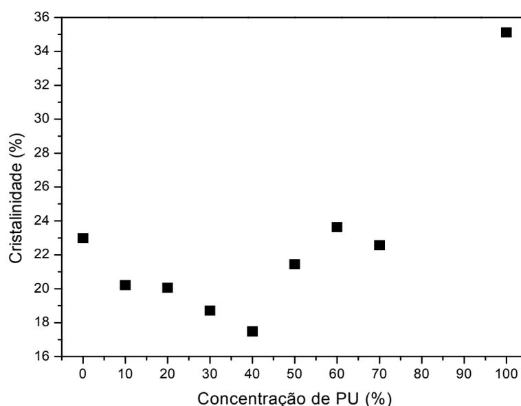
Figura 34 – Porcentagem de cristalinidade das blendas com relação a concentração de PU.
