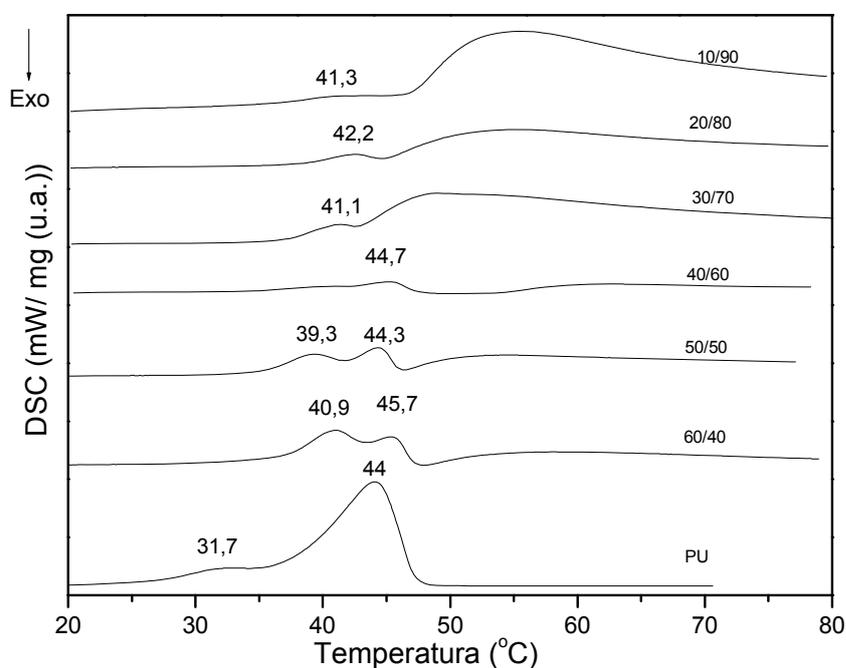
Figura 32 – Curvas de DSC para os polímeros puros e para as redes PU/QTN, no segundo aquecimento.
