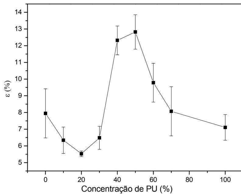
Figura 47 – Deformação em função da concentração de PU nas blendas PU/QTN.
