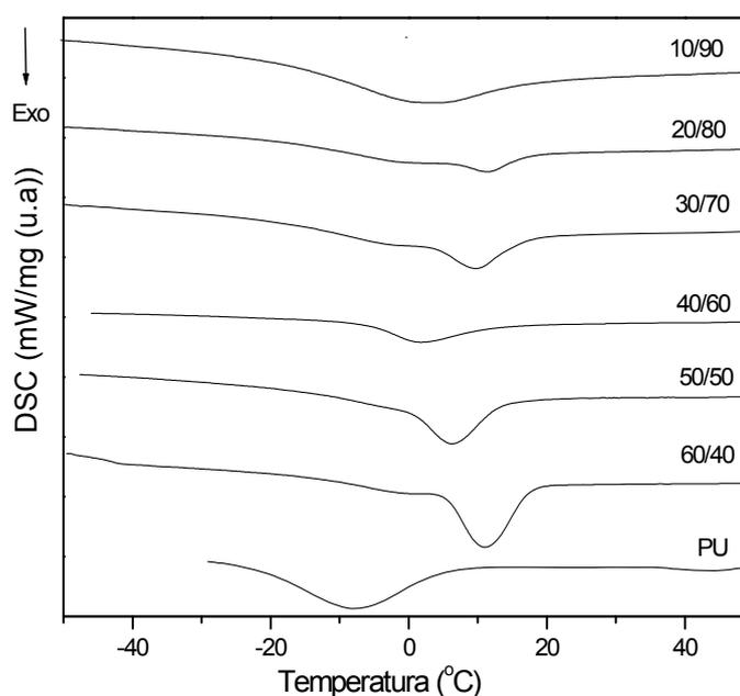
Figura 31 – Curvas de DSC para os polímeros puros e para as redes PU/QTN, no resfriamento.
