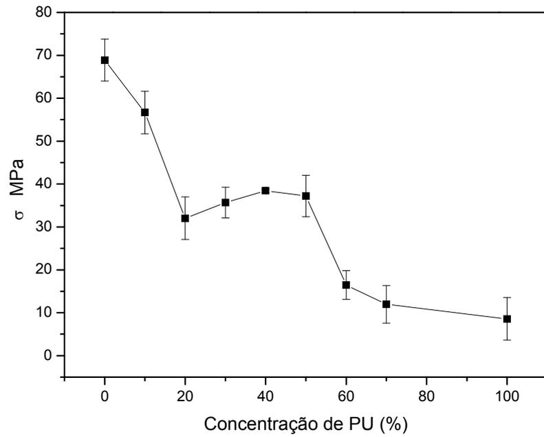
Figura 46 – Tensão na ruptura em função da concentração de PU nas blendas PU/QTN.
