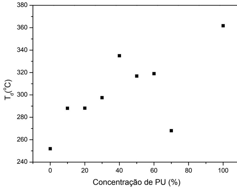
Figura 24 –  $T_d$  em função da concentração de PU presente nas redes.
