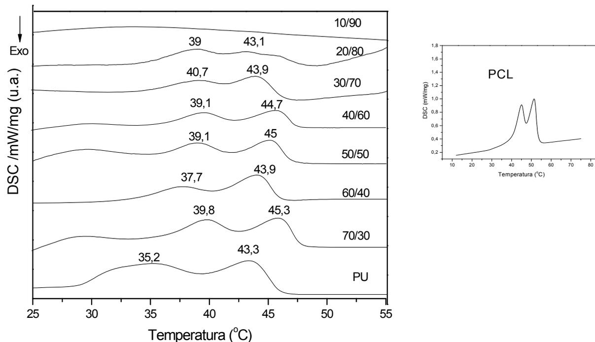
Figura 29 – Curvas de DSC para os polímeros puros e para as blendas PU/QTN, no segundo aquecimento.
