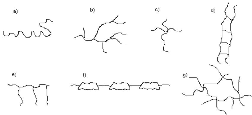
Figura 01 - Tipos de moléculas poliméricas: a) linear; b) ramificado; c) com ramificações em estrela; d) escalar; e) graftizado ou enxertado; f) semi-escalar; g) com ligações cruzadas ou reticuladas.
