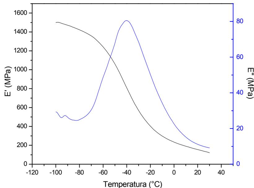
Figura 36 – Módulo de armazenamento (E') e de perda (E'') para o filme de PU.
