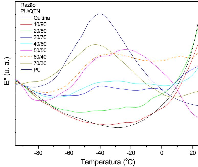
Figura 40 – Módulo de perda ( $E''$ ) para as redes PU/QTN.
