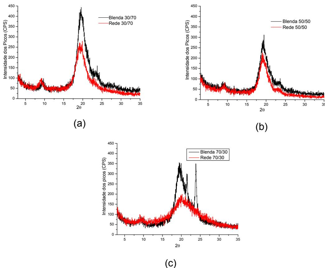
Figura 35 – Difratoograma de raios X: a ) blenda e rede 30/70, b) blenda e rede 50/50 e c) blenda e rede 70/30.
