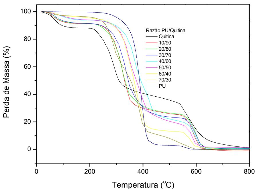
Figura 23 – Curvas termogravimétricas em várias composições das redes PU/QTN.
