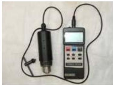
FIGURA 10 – Torquímetro Modelo TQ 680
