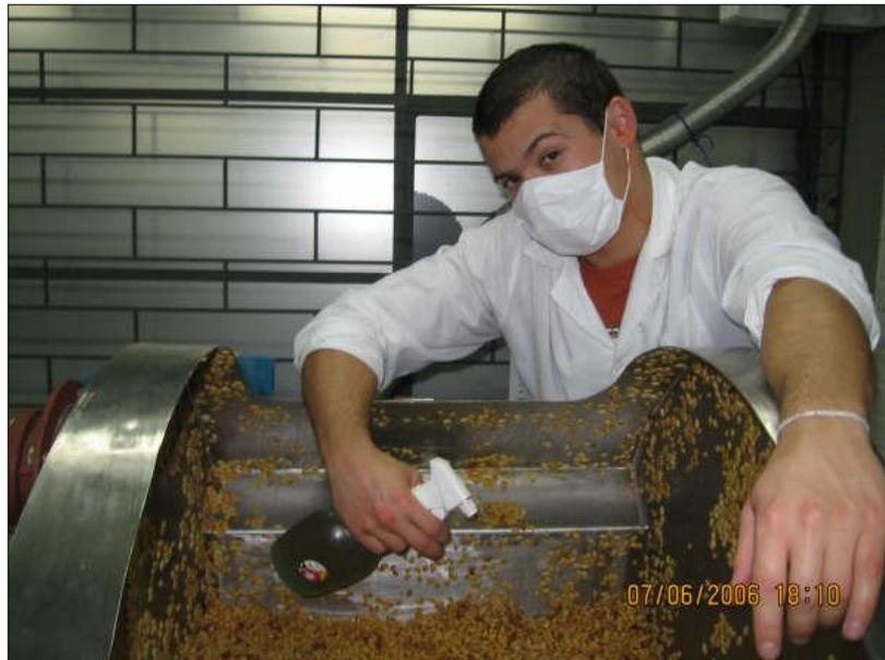
FIGURA 24. Inoculação dos esporos no biorreator.
