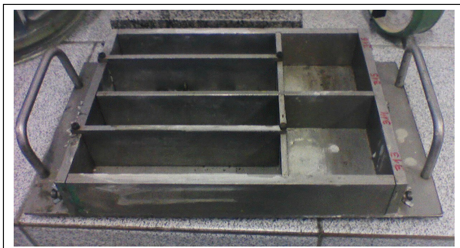
FIGURA 7: FÔRMA PARA ENSAIO DE RESISTÊNCIA À TRAÇÃO NA FLEXÃO.
