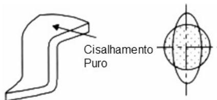
**Figura 2.1.12** – Embutimento ou cisalhamento puro em uma flange de um copo embutido.
