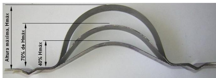
**Figura 6** - Seqüência de embutimento realizado no ensaio de Nakazima para produzir peças com diferentes níveis de deformação.
