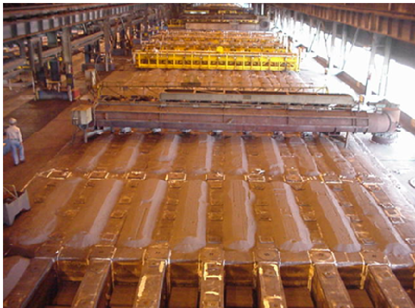
Figura 7 Forno de cozimento de anodos.
