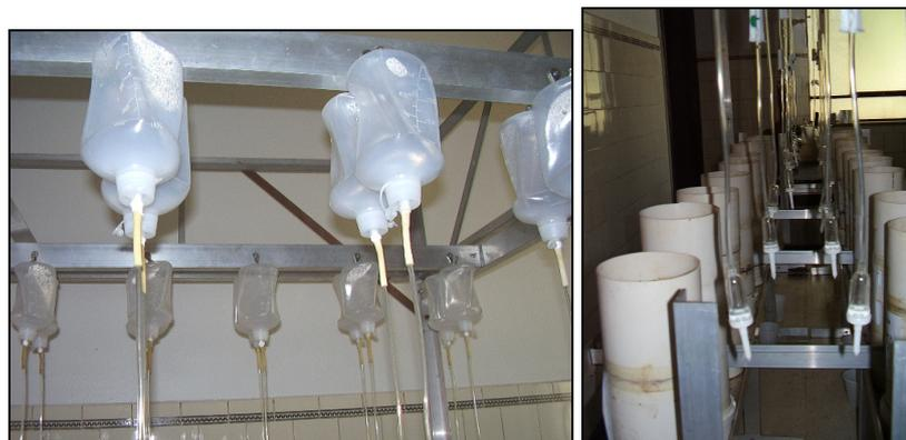
**Figura 5.** Pinça Rolete para passagem da solução  $\text{HNO}_3$   $0,1 \text{ mol L}^{-1}$
