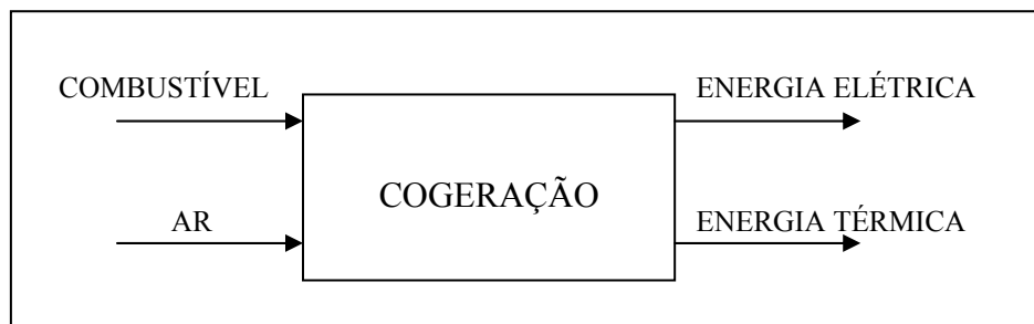
FIGURA 10 – INSUMOS E PRODUTOS EM UM SISTEMA DE COGERAÇÃO FONTE: O autor (2007).
