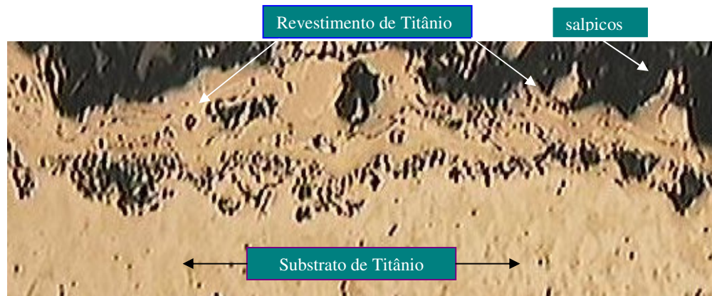
Figura 24. Corte transversal do revestimento de titânio depositado por aspersão térmica a plasma spray (100X).
