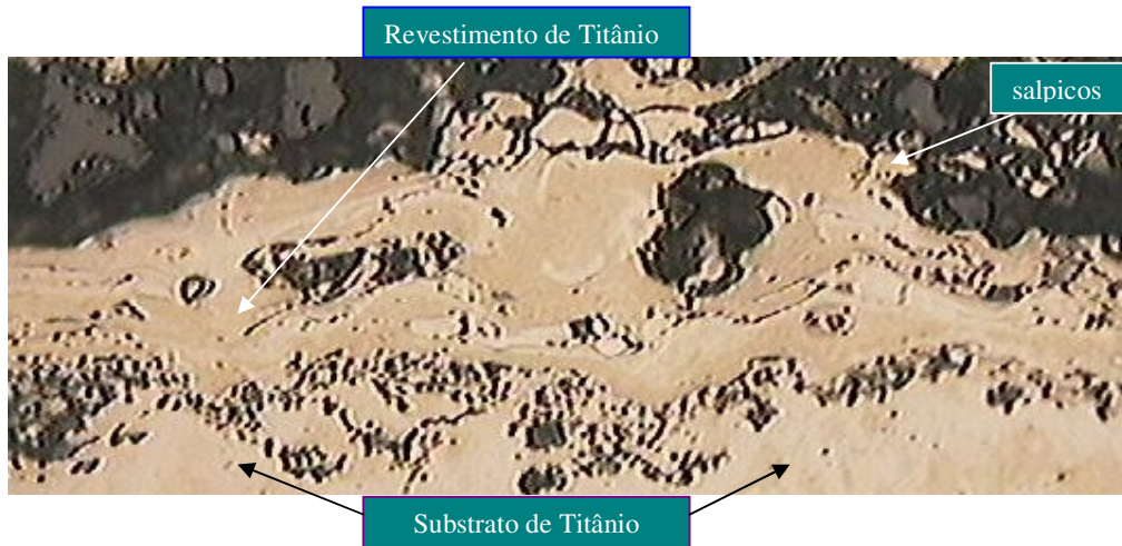
Figura 26. Corte transversal do revestimento de titânio depositado por aspersão térmica a plasma spray (400X).
