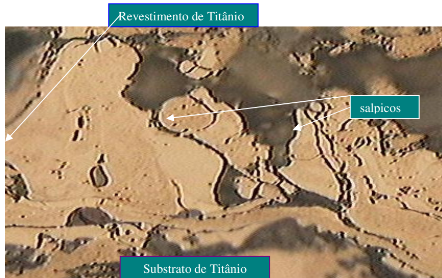
Figura 27. Corte transversal do revestimento de titânio depositado por aspersão térmica a plasma spray (500X).
