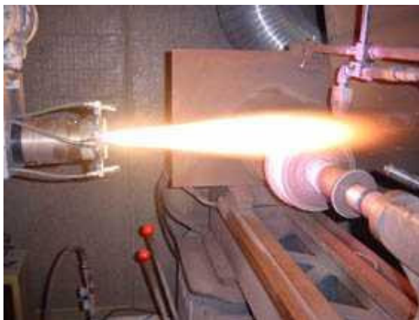
Figura 10. Deposição de materiais através de tocha plasma spray.
