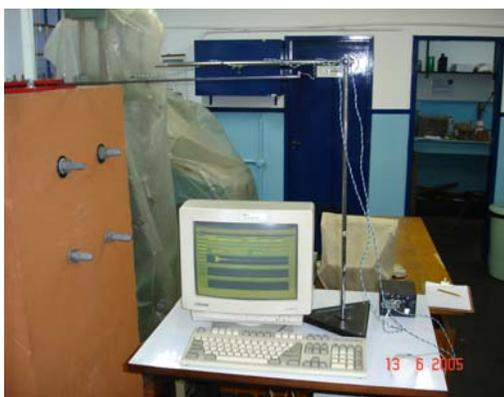
Figura 5.2 – Sistema de Aquisição de Dados no local dos experimentos.
