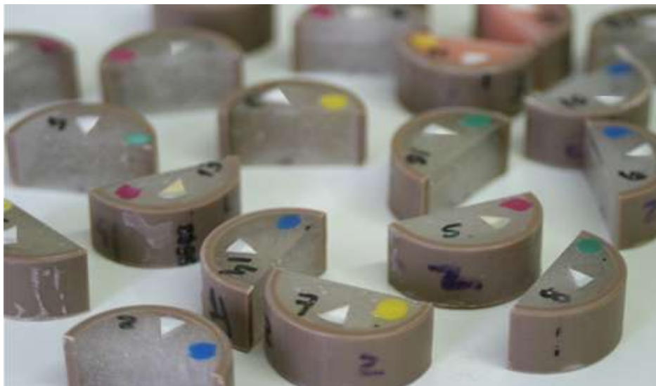
Figura 4.2- Espécimes embutidos em resina acrílica, lixados e polidos
