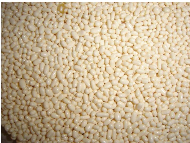
**Figura 60-** Fotografia das pérolas obtidas na polimerização em suspensão do poliestireno com o material bactericida.
