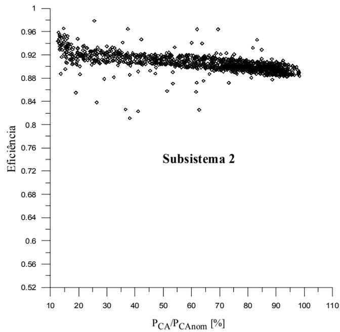
**Figura 5.8** Curva de eficiência do inversor no subsistema 2.
