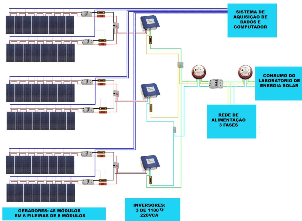
**Figura 3.4** Esquema ilustrativo das ligações da instalação fotovoltaica.
