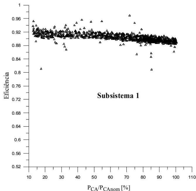
**Figura 5.7** Curva de eficiência do inversor no subsistema 1.
