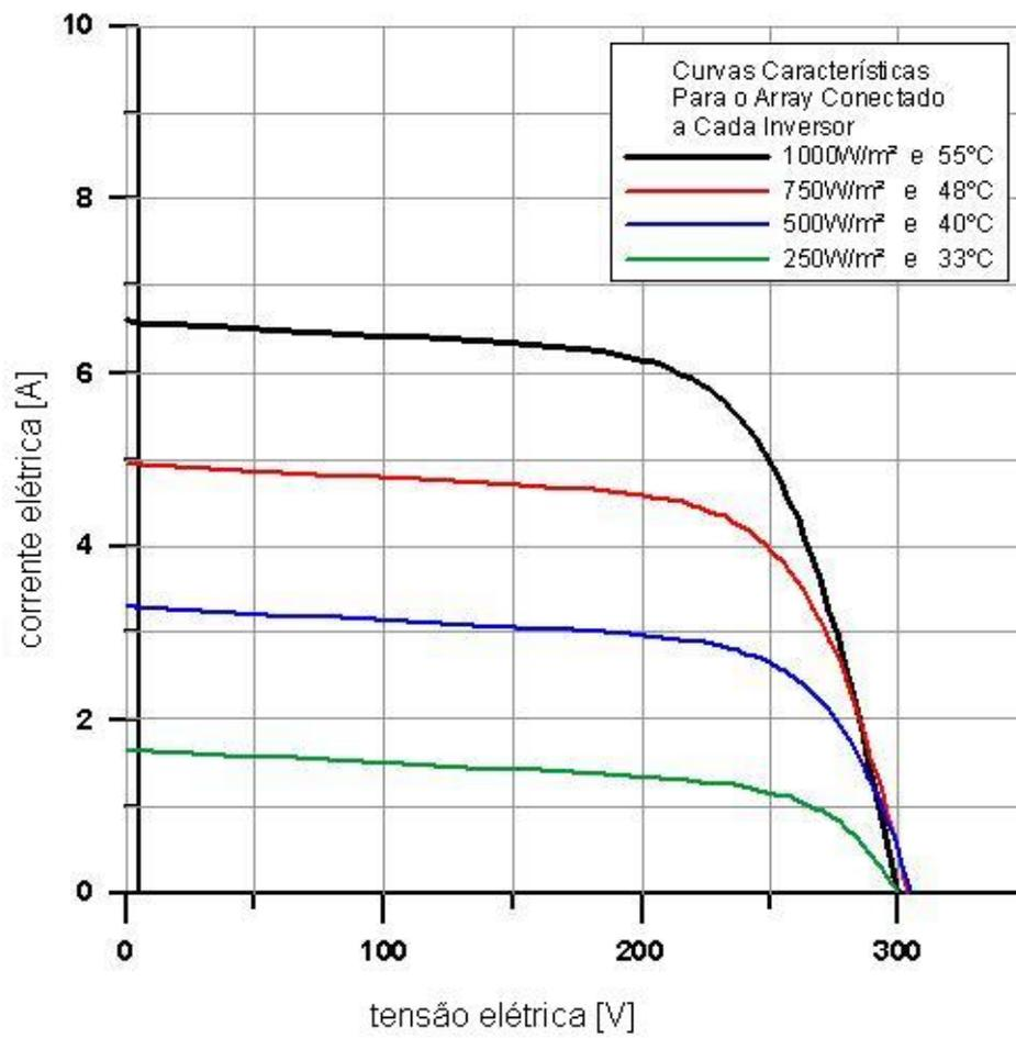
**Figura 3.6** Curvas características I&V para diversas condições de operação de um arranjo com 16 módulos formado por dois painéis paralelos de 8 módulos em série. A tensão de operação varia entre 230 e 280 V<sub>CC</sub>.
