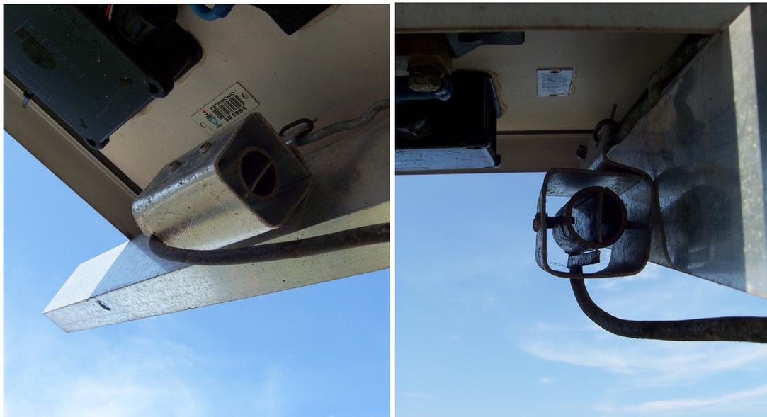
**Figura 4.9** Medidor da temperatura do ar ambiente.
