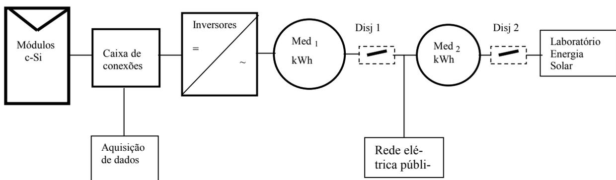
**Figura 3.3** Diagrama em blocos das ligações da instalação fotovoltaica.
