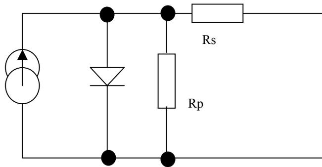
**Figura 2.1** Circuito equivalente de uma célula fotovoltaica.
