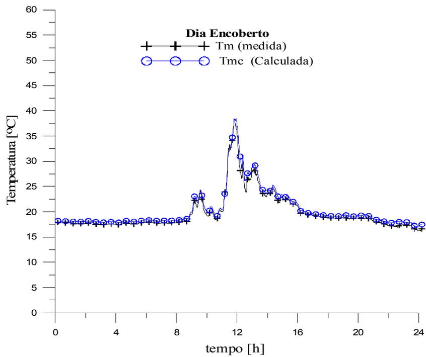
**Figura 6.6** Teste da correlação  $Tmc$  em um dia encoberto.
