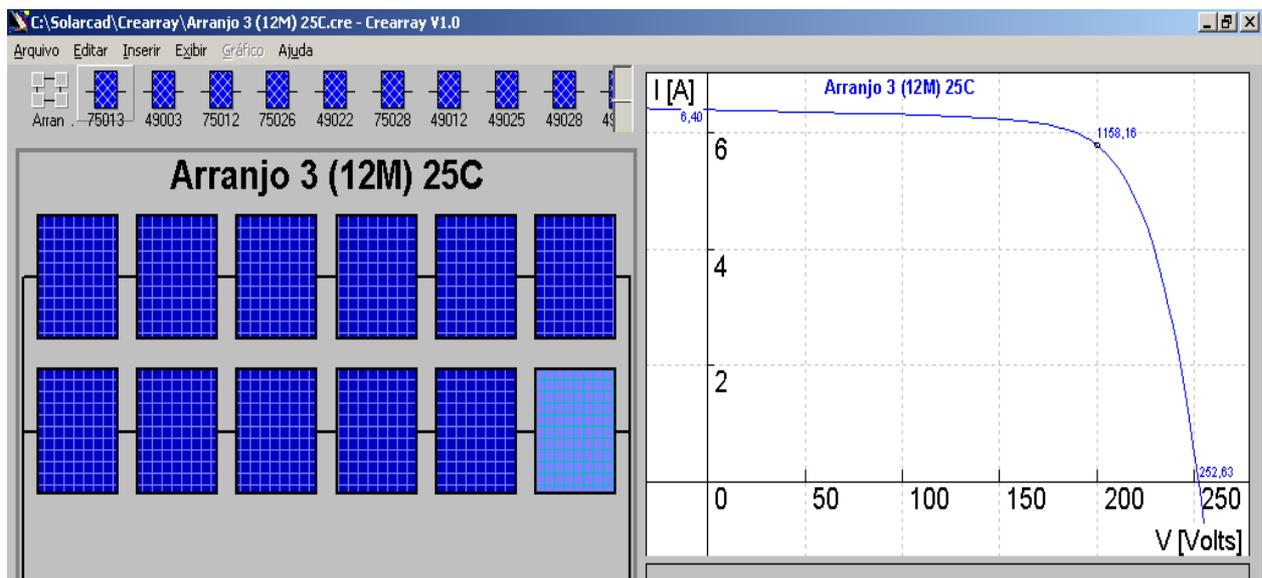
Figura 3 Arranjo do subsistema 3 com 12 módulos modelo I-100/24.
