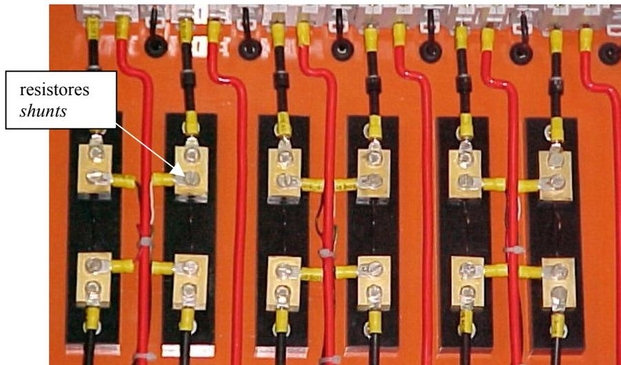
**Figura 4.8** Resistores *shunts*
