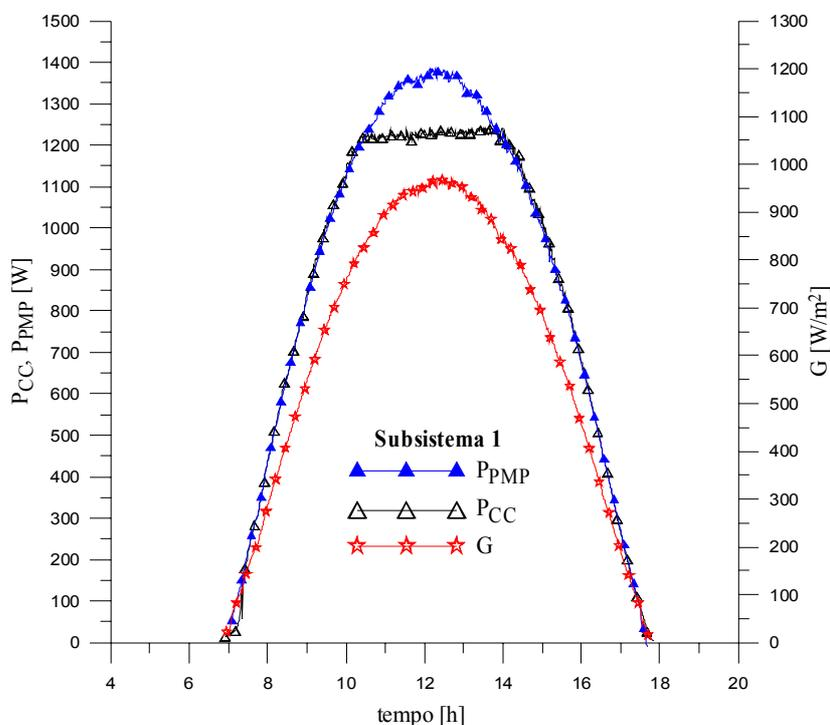
**Figura 7.8** Curvas de potência, permitindo visualizar e energia perdida no patamar do subsistema 1.
