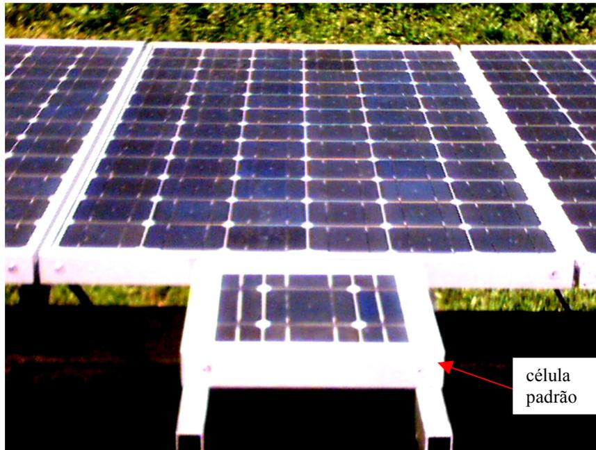
**Figura 4.12** Célula padrão para medir a irradiância no plano do gerador.
