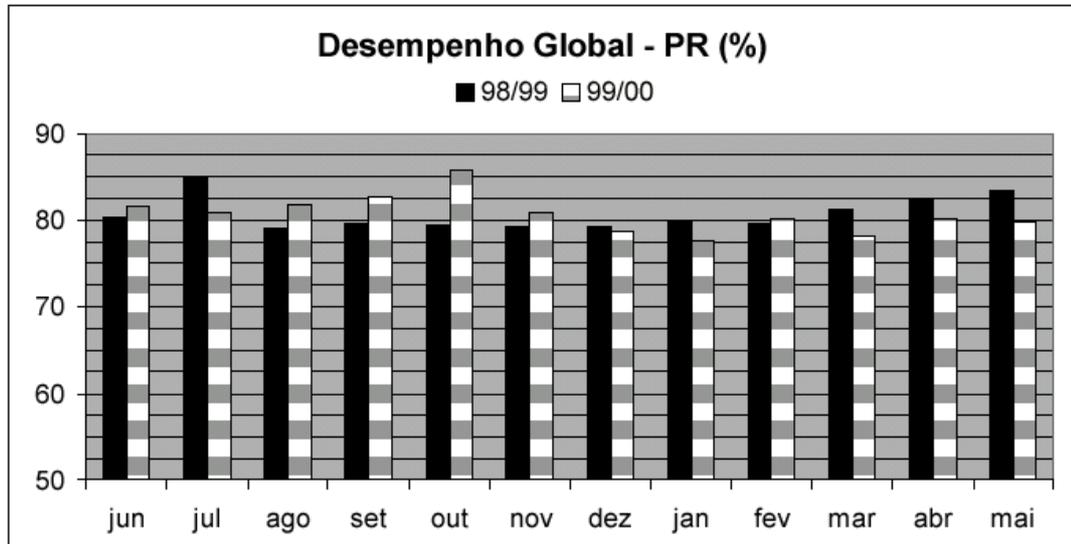
**Figura 2.10** Desempenho global do sistema *PR* instalado no IEE/USP, referente a dois anos de operação, de junho de 1998 a maio de 2000 [Oliveira, 2002].
