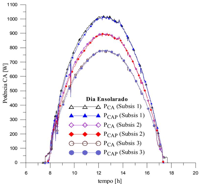
**Figura 6.18** Comparação entre as potências injetadas na rede medida e calculada com as correlações, para os três subsistemas em um dia ensolarado.
