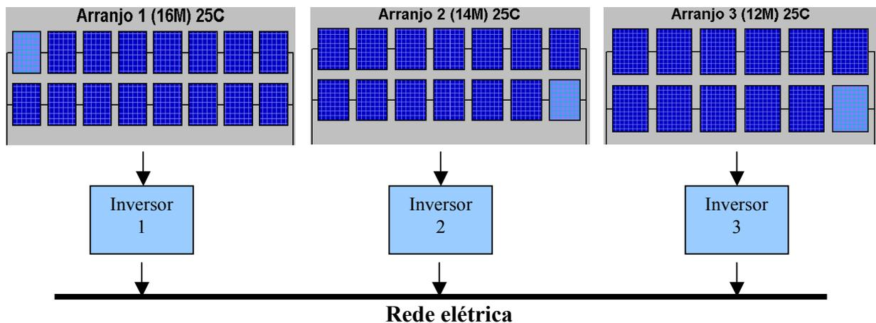
**Figura 7.1** Vista esquemática dos três subsistemas da instalação.
