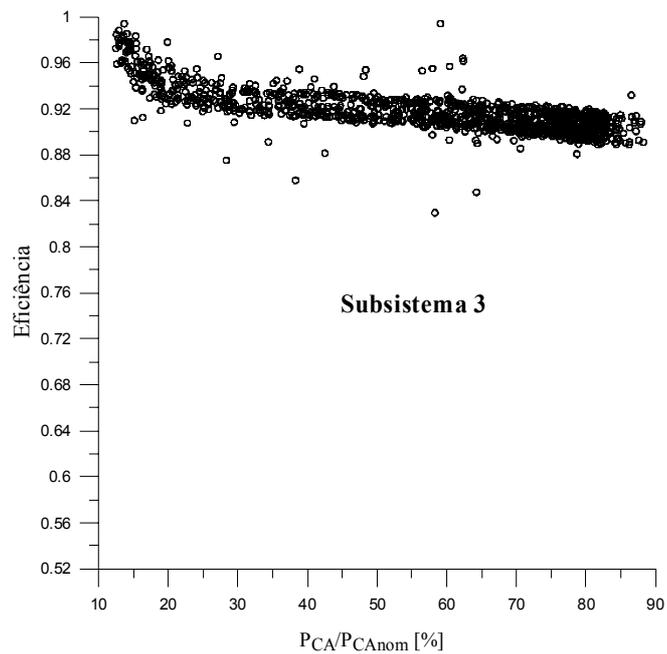
**Figura 5.9** Curva de eficiência do inversor no subsistema 3.
