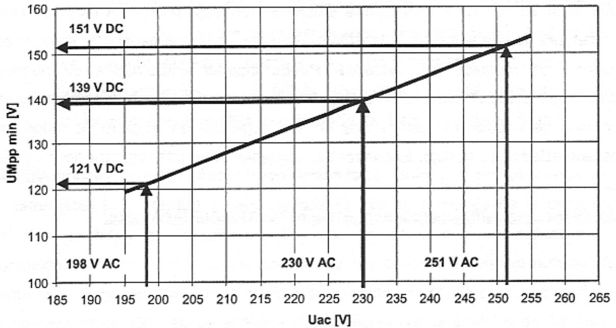
**Figura 2** Tensão mínima no ponto de máxima potência em função da tensão de conexão da rede [SMA Technologie AG, 2003].
