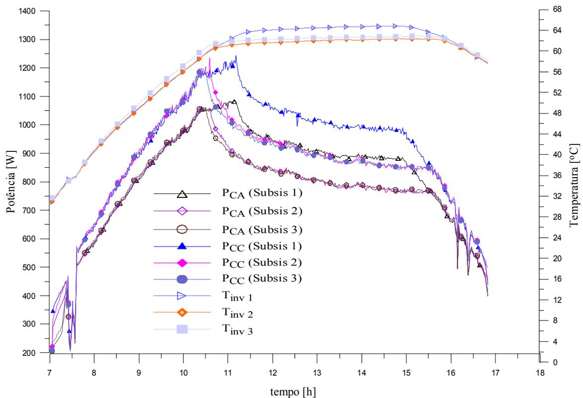
**Figura 5.14** Curvas de potência CC e CA e temperatura de cada inversor em função do tempo.
