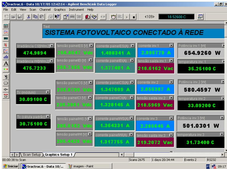
Figura 2 Tela de resultados mostrando todas as medidas às 9h17min. (dia ensolarado).
