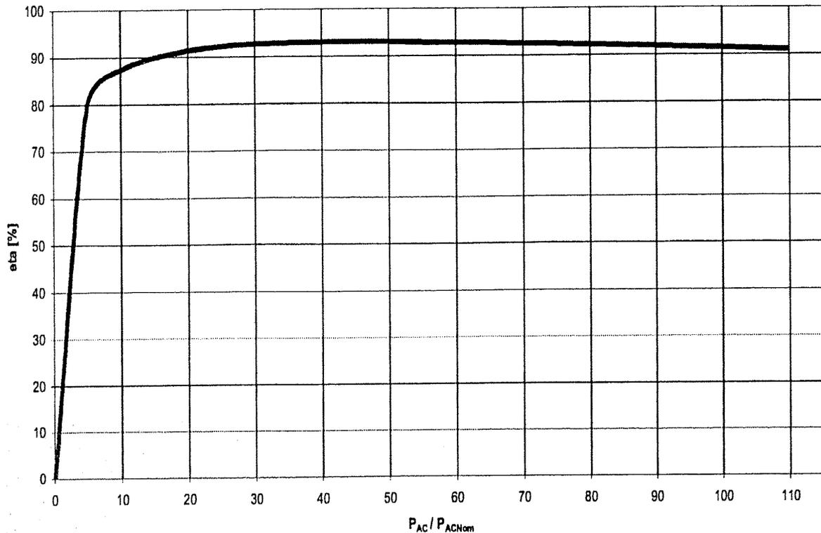
**Figura 2.2** Curva da eficiência do inversor [SMA Technologie AG, 2003].
