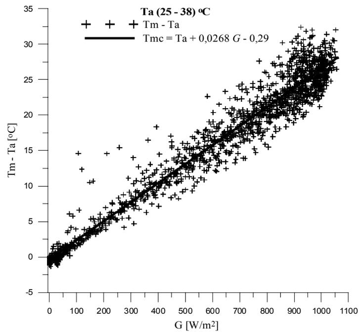
**Figura 6.3**  $T_m - T_a$  em função de  $G$  na faixa de  $T_a$  (25 – 38)°C.
