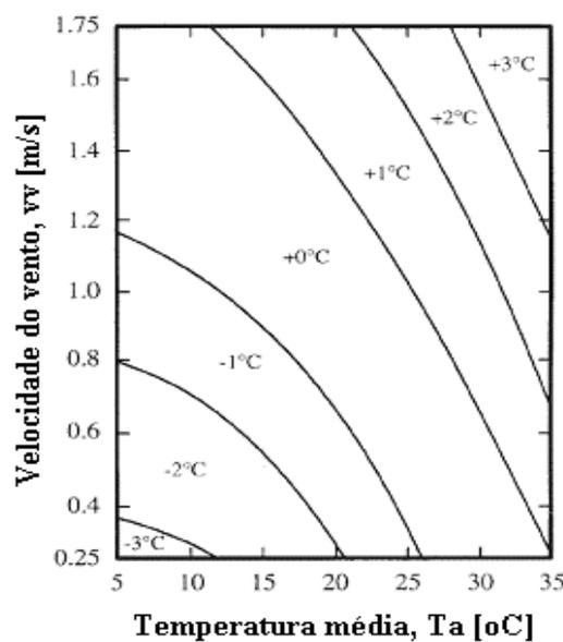
**Figura 6.1** Fator de correção para *NOCT* [ASTM E-1036, 2002].
