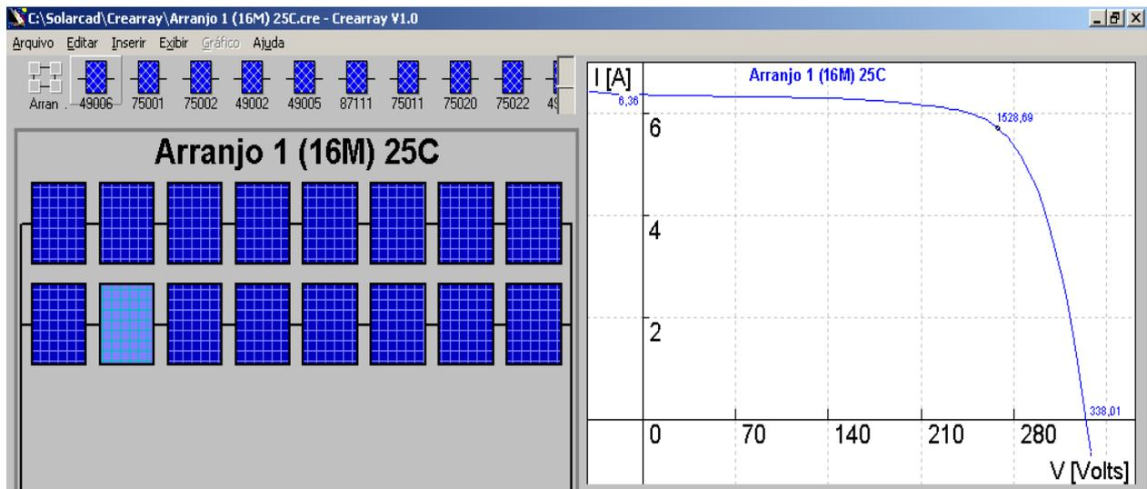
Figura 1 Arranjo do subsistema 1 com 16 módulos modelo I-100/24.
