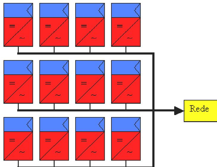
**Figura 2.6** Inversor com módulo integrado ou módulo CA.
