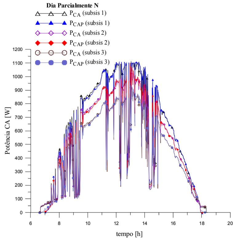
**Figura 6.19** Comparação entre as potências injetadas na rede medida e calculada com as correlações, para os três subsistemas em um dia parcialmente nublado.
