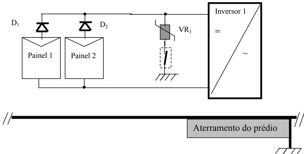
**Figura 4.5** Instalação do dispositivo de proteção contra sobre-tensões e diodos de bloqueio.
