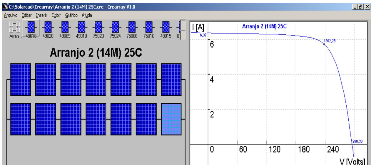
Figura 2 Arranjo do subsistema 2 com 14 módulos modelo I-100/24.
