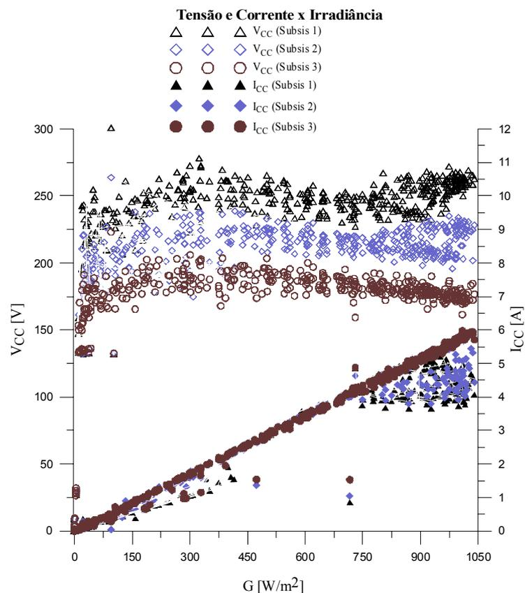
**Figura 5.4** Tensões e correntes elétricas nas entradas dos inversores em função da irradiância.
