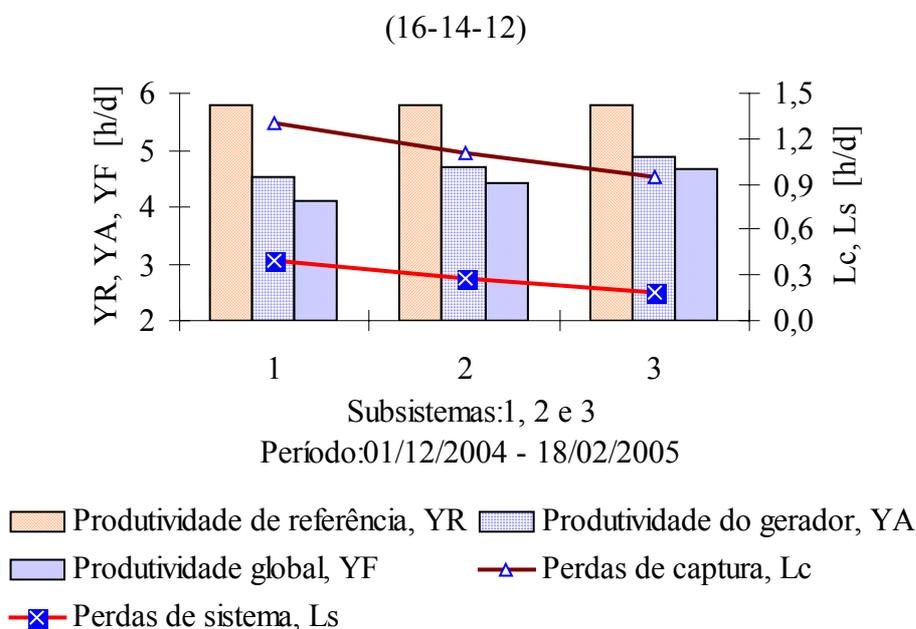
**Figura 1** Valores médios das produtividades do gerador e de sistema e das perdas  $L_c$  e  $L_s$ , em cada subsistema.
