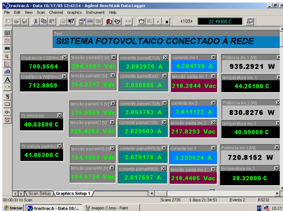
Figura 3 Tela de resultados mostrando todas as medidas às 10h17min. (dia ensolarado).
