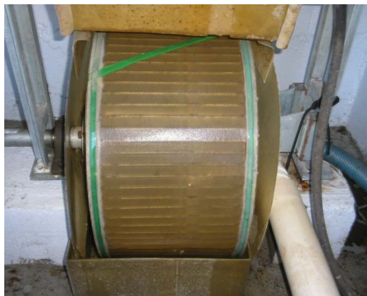
Figura 12. Filtro Rotatório com malha de 800 \mu\text{m} do sistema de recirculação
