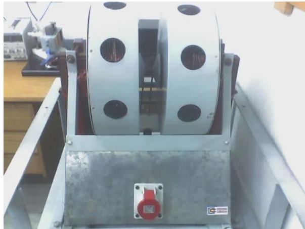
Figura 1.25 - O eletroímã de frente. Aparece aqui o conector principal da fonte e as janelas de convecção.
