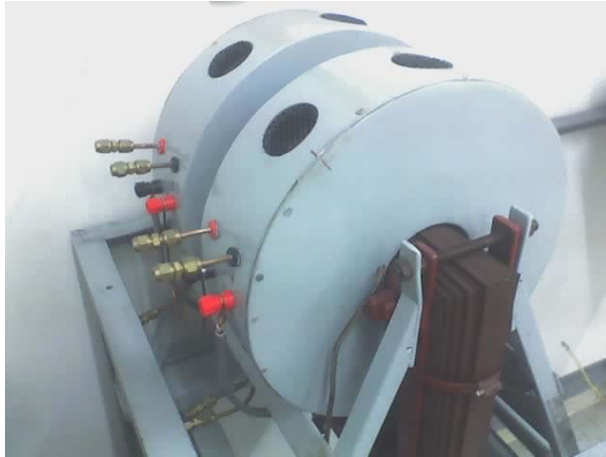
Figura 1.26 - O eletroímã de perfil. Aparecem aqui os terminais elétricos de cada bobina e conexões para o sistema de arrefecimento.
