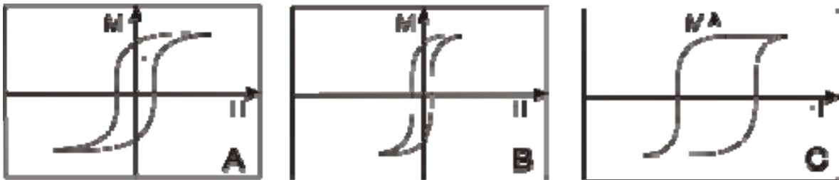
Figura 1.3 - Em A, material ferromagnético comum; em B, material com tratamento especial, usado como núcleo de motores e transformadores; e em C material para ímãs permanentes.
