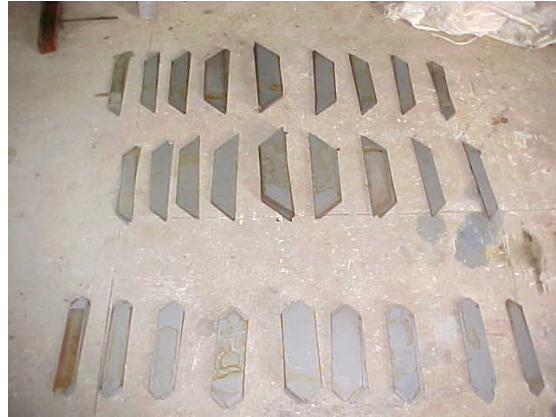
Figura 1.7 - Lâminas de FeSi espalhadas pertencentes ao núcleo do eletroímã.(com 0,3 mm de espessura)
