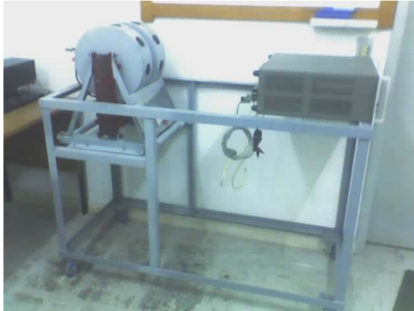
Figura 1.28 - Estrutura de suporte. Sob a estrutura estão o eletroímã e a fonte de corrente.
