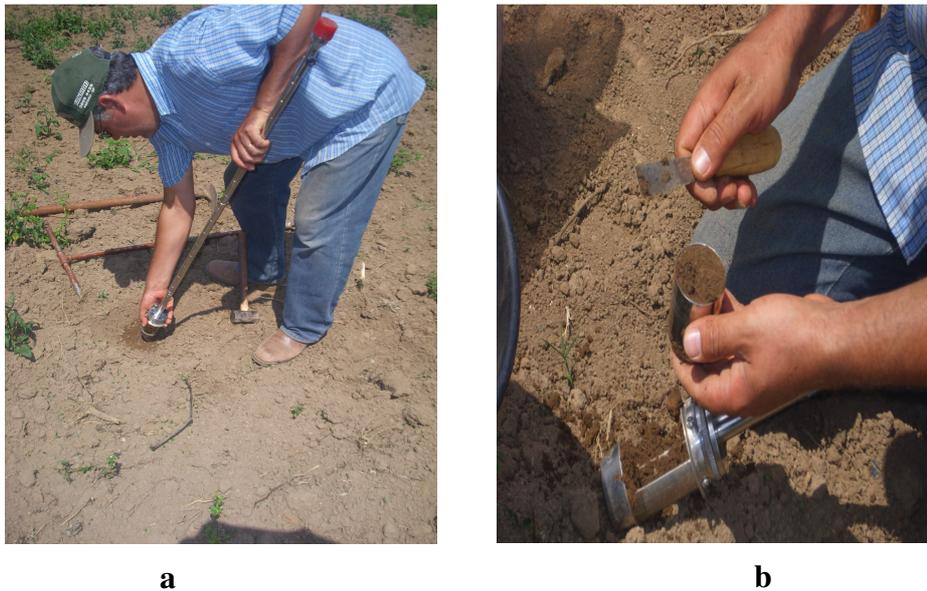
**Figura 1** - Coleta de amostras para análise de densidade do solo pelo método do anel volumétrico em propriedade convencional: **a**. Utilizando o auxílio do “castelinho”; **b**. Removendo o excesso de solo. Sítio São José, Socorro/SP. 2008 (Fotos: Araci Kamiyama).
