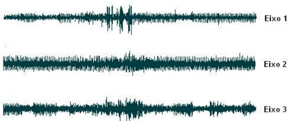
FIGURA 37. Sinais de MMG dos 3 eixos do acelerômetro em um mesmo intervalo de tempo.
