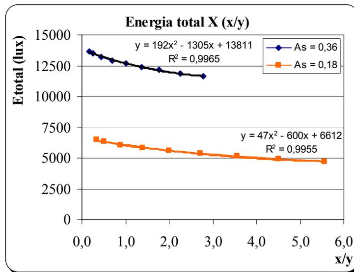
**Figura 5.6:** Energia Total em função da relação x/y, para áreas do DL de 0,18m<sup>2</sup> e 0,36 m<sup>2</sup>.
