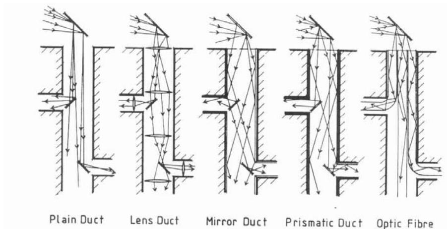
**Figura 2.6:** Esquemas de redirecionamento da luz solar. (MACEDO, 2002)
