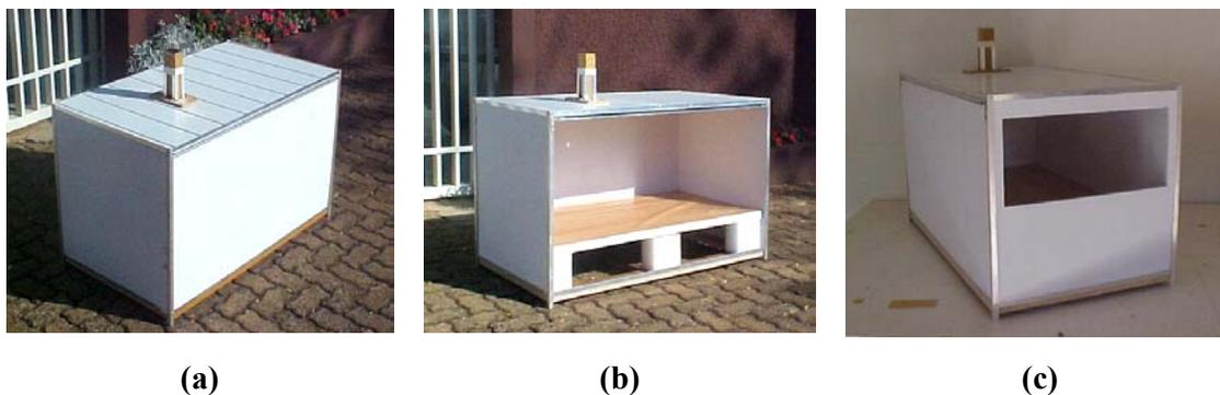
**Figura 3.3:** (a) Maquete usada, com Duto de Luz. (b) Vista interna da maquete. (c) Maquete com janela e duto.
