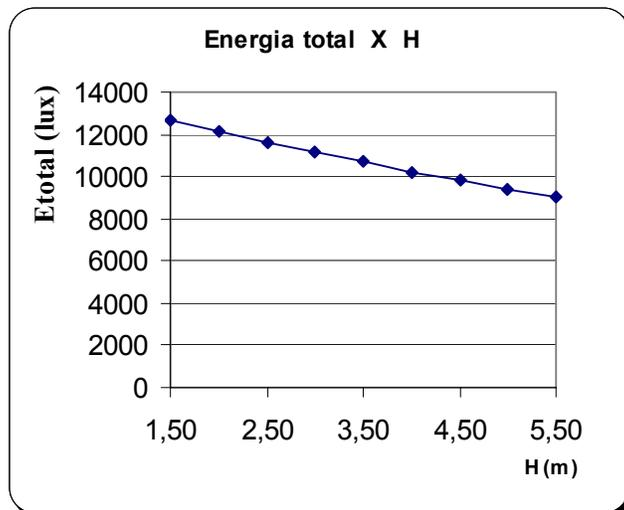
**Figura 5.8:** Energia em função da altura do DL.
