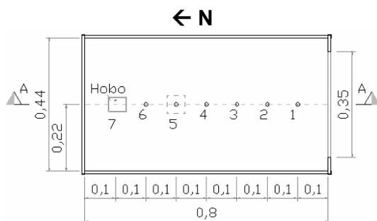
**Figura 3.14:** Planta da maquete usada.
