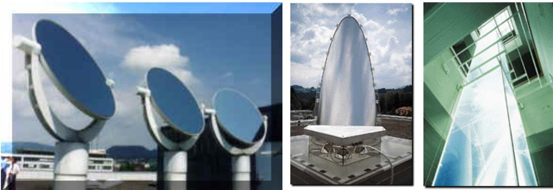
**Figura 2.5:** Sistemas de coleta, distribuição e emissão da luz natural. (MACEDO, 2002)
