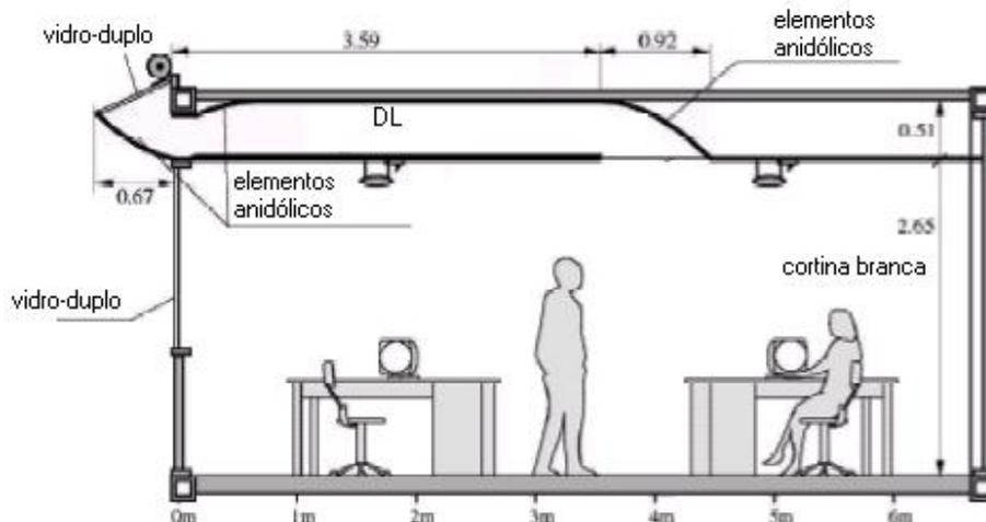
**Figura 2.7:** Esquema de DL horizontal. (COURRET et al., 1998)
