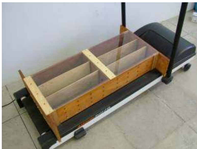
Figura 2 – Imagem detalhada das raia adaptadas na esteira ergométrica utilizada para o treinamento dos animais (FERRAZ, 2007).
