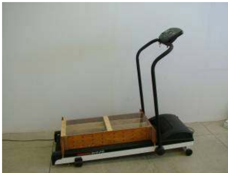
Figura 1 – Imagem ilustrativa da esteira ergométrica adaptada utilizada para o treinamento dos animais (FERRAZ, 2007).
