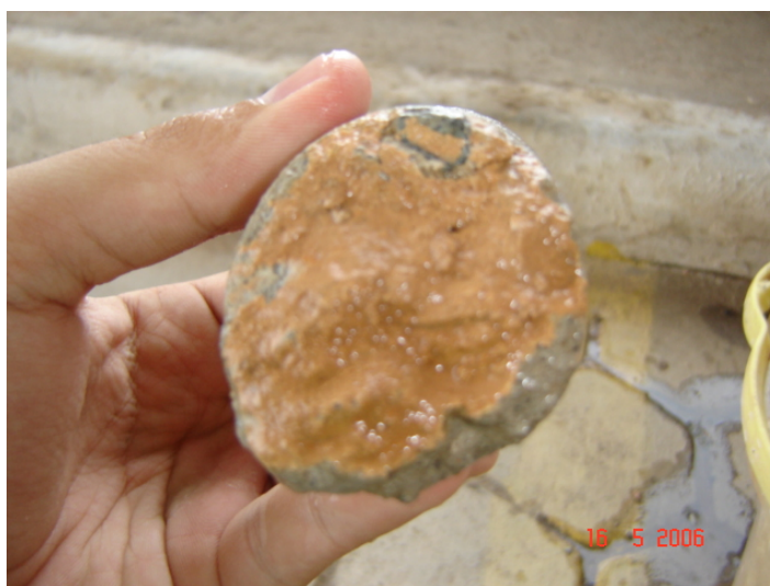
Figura 5.43 – Extração de testemunho antes da de lavagem das trincas.
