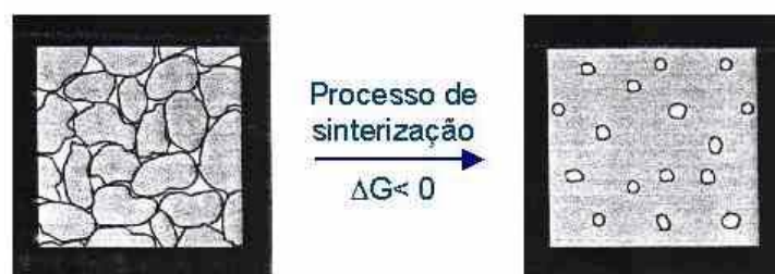
Figura 13 - Sinterização como uma mudança de estado termodinâmico [43].
