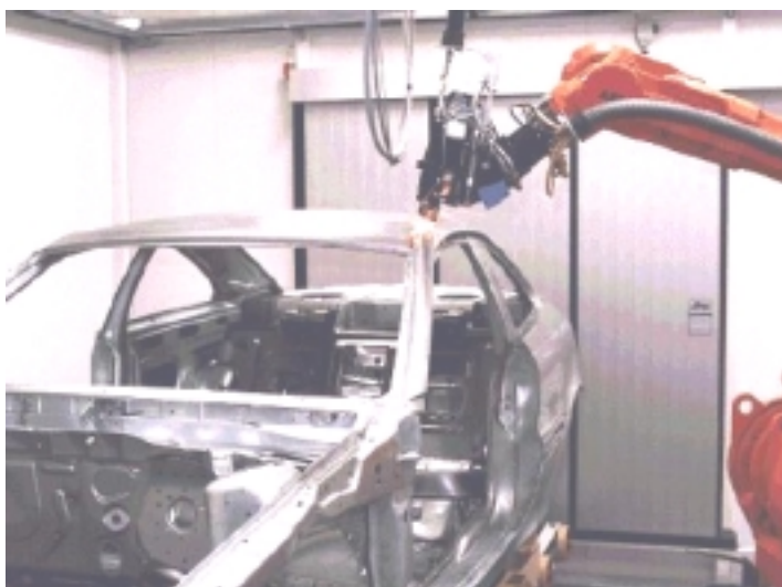
Figura 2.11 - Soldagem por laser (Nd:YAG bombeado a diodo) Volvo. [48].
