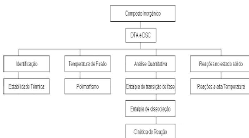
Figura 6.20 – Aplicação das técnicas DSC e DTA para compostos inorgânicos [43].
