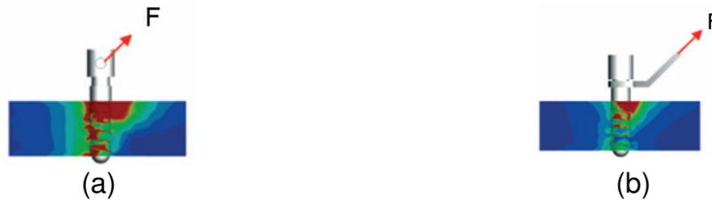
Figura 2.17 - Perfil de tensões no osso cortical sob carregamentos: (a) Direto; (b) Com extensor - (Figs. baseadas em Motoyoshi et al., 2005).
