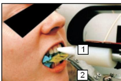
Figura 3.18 - Dispositivos utilizados nos experimentos de Jones et al. (2001) para: (1) Aplicação de força; (2) Leitura do deslocamento. (Fig. baseada em Jones, 2001).
