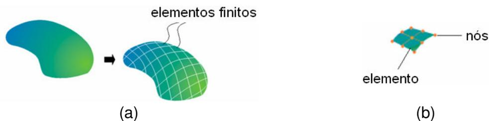
Figura 2.2 – (a) Objeto original e discretizado em elementos finitos; (b) Um único elemento e seus nós.
