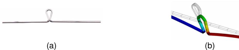
Figura 2.31 - Alça em forma de gota: (a) Fotografia; (b) Ilustração de simulação computacional - (Figs. baseadas em Coimbra et al., 2007).
