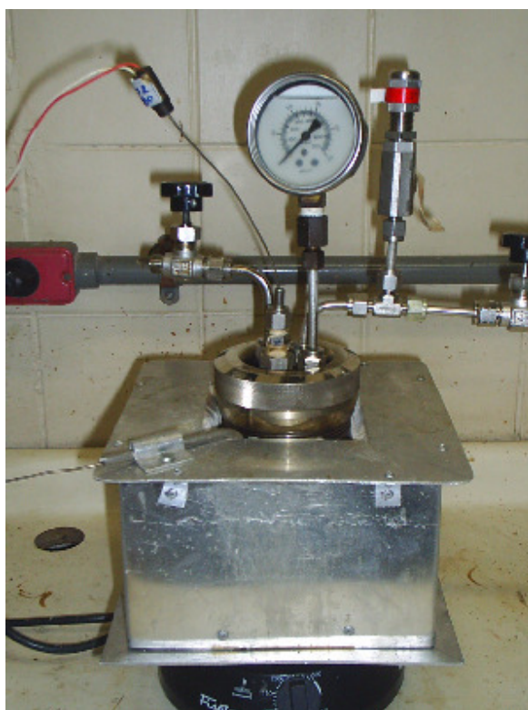
Figura 20: Foto do reator utilizado nas reações de dimerização
