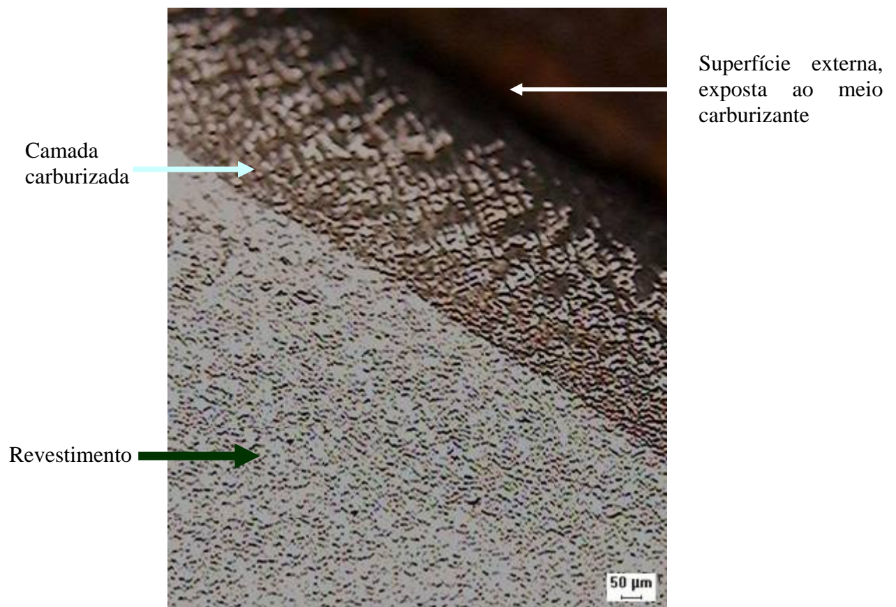
Figura 4.12 – Microestrutura de M.O. do revestimento de Ni-Mo-Cr Carburizado na presença do carvão com ativador a 850 °C.
