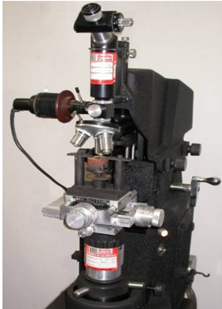
Figura 3.6 – Microdurômetro utilizado, instalado no LaMaTS
