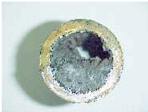
Figura 2.3 – Coque de gasóleo pesado no tubo pré-aquecedor [EHRIM et al. (2005)].
