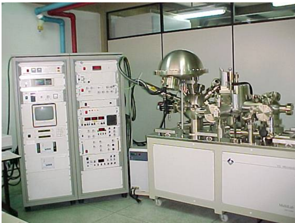
Figura 3.13 – Aparelho de XPS utilizado, instalado no laboratório de Superfícies e Interfaces.
