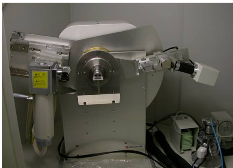
Figura 3.12 – Difratômetro de Raios-X utilizado instalado, no Laboratório de Óptica de Raios-X e Instrumentação.
