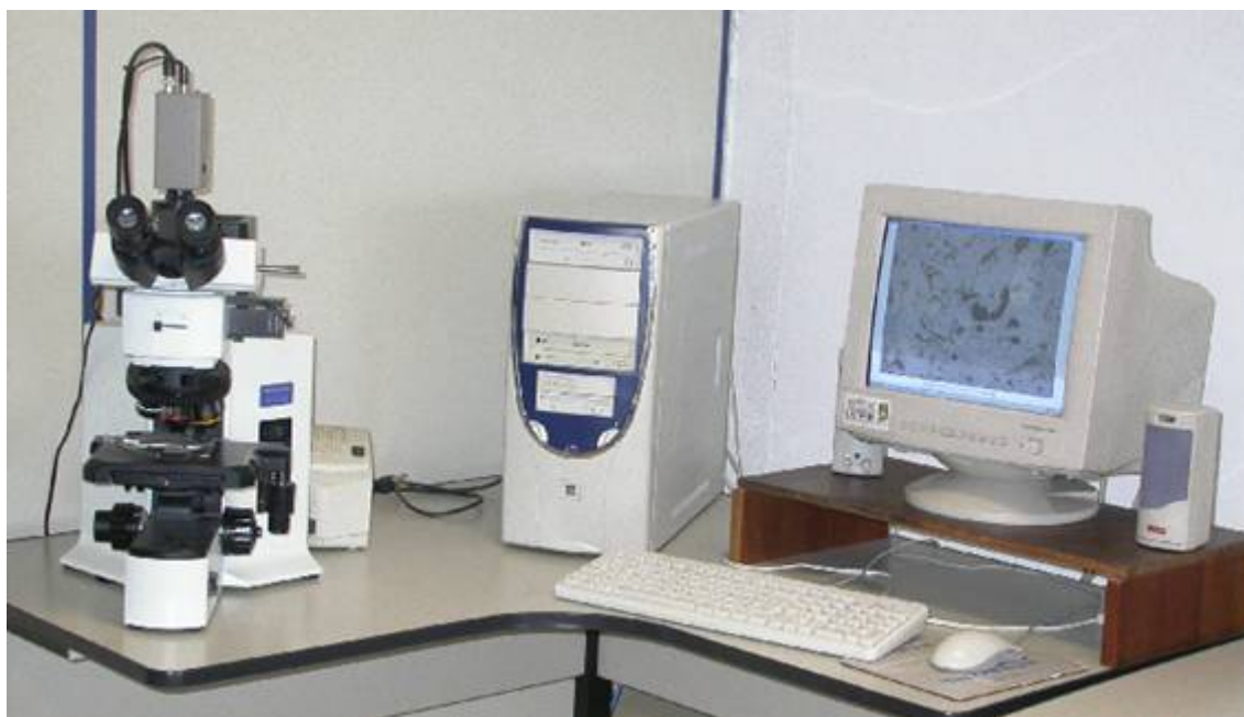
Figura 3.10 – Microscópio ótico utilizado para revelar as microestruturas, instalado no LaMaTS
