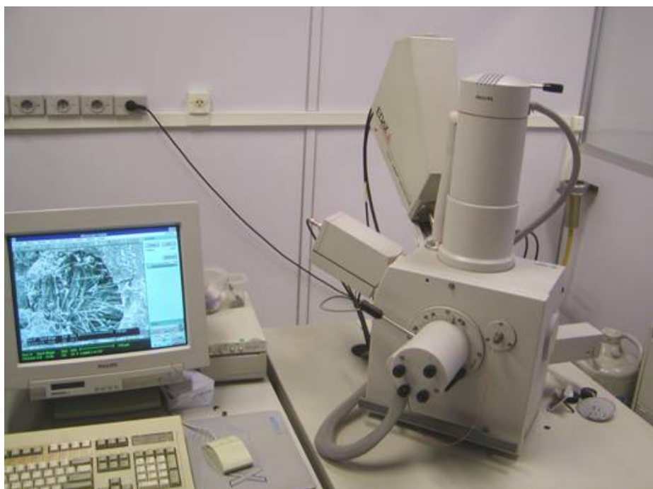
Figura 3.11 Microscópio eletrônico de varredura utilizado para revelar as microestruturas, instalado no Lactec.
