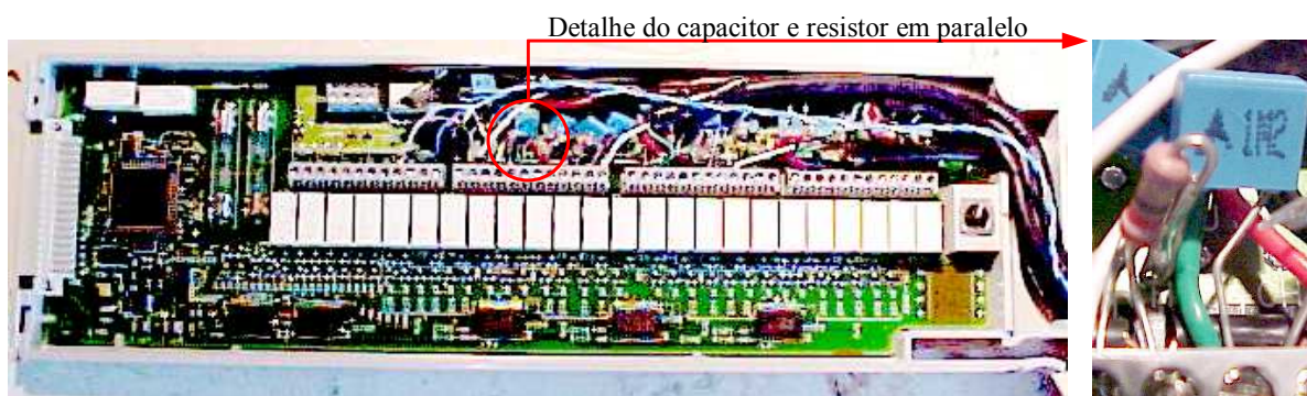
Figura 3.13 – Conexão dos sensores C.I. ao cartão multiplexador HP 34970A.
