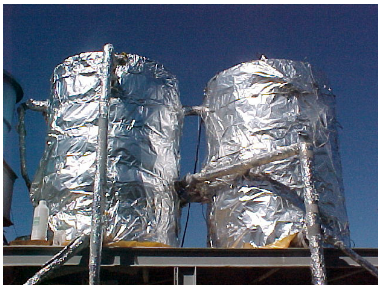
Figura 4.9 – Blindagem de alumínio para radiação solar.
