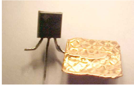
Figura 3.10 – LM35 com massa térmica na perna do terra.
