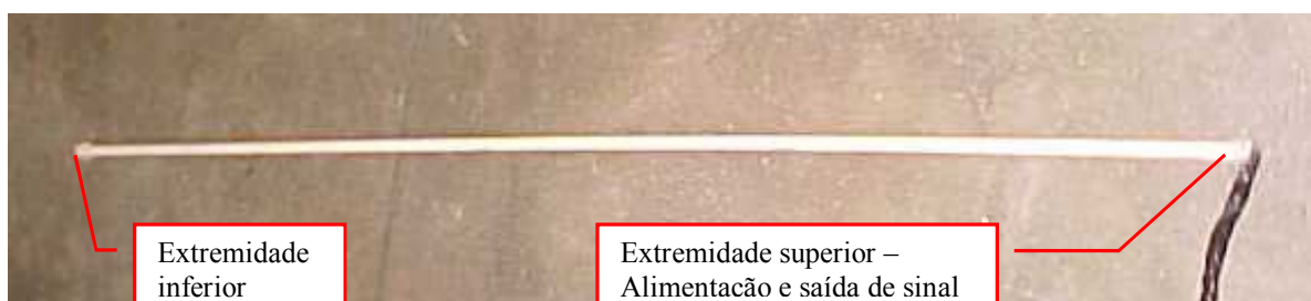
Figura 3.11 – Haste de CPVC com LM35 em seu interior.
