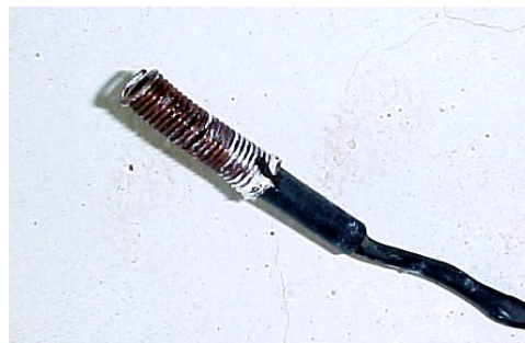
Figura 3.8 – Isolamento elétrico do PT100.
