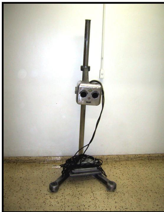
**Figura 4:** Aparelho de raios X monofásico G. E. portátil de 50 KV.
