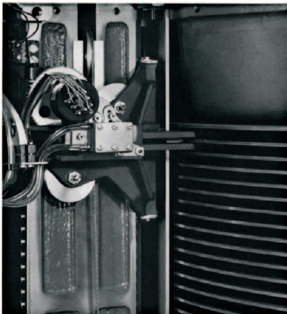
Figura 1.1: Ramac 350, primeiro registro de disco rígido, produzido pela IBM.
