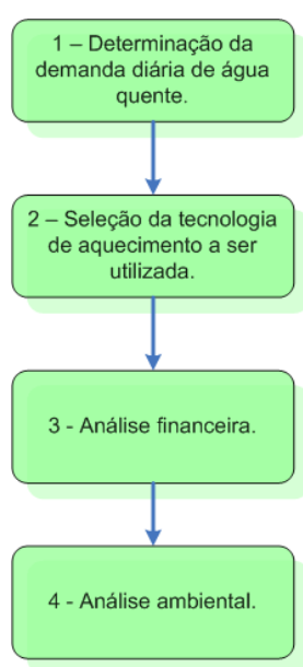
Figura 18 – Passos para projeto de sistema de aquecimento.
