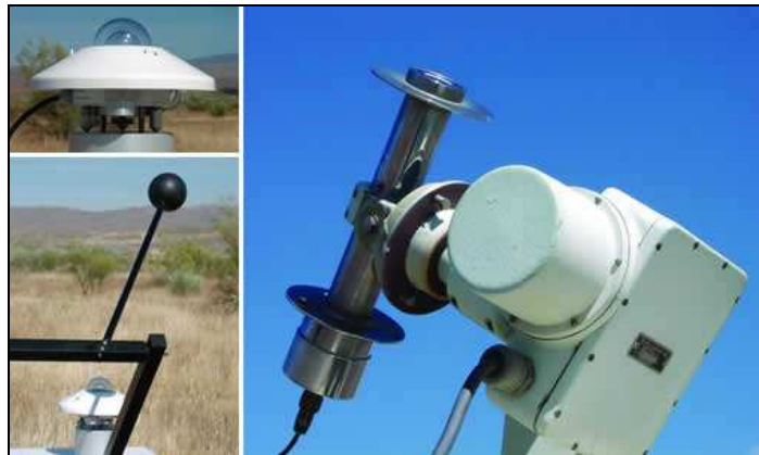
Figura 26 – Piranômetros e pireliômetros medindo a radiação global, difusa e direta.
