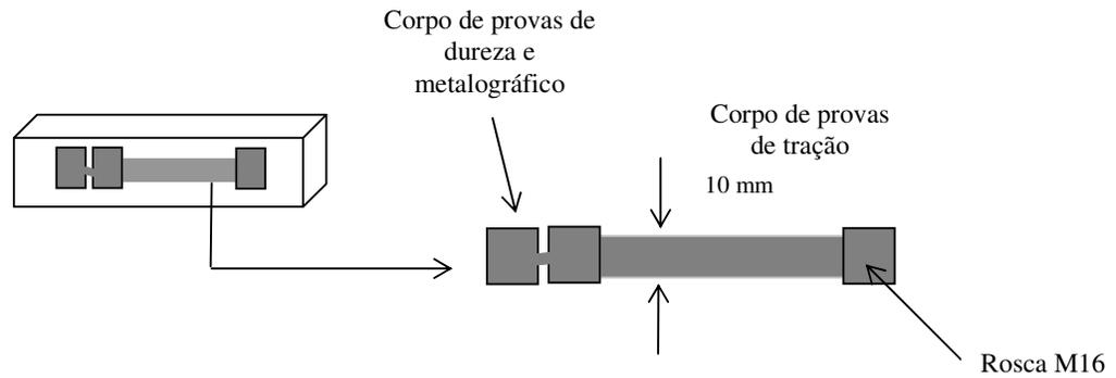
**Figura 3.3** – Regiões onde foram retirados os corpos de prova de tração, dureza e metalográfico.
