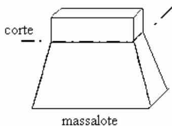
**Figura 3.2:** Esquema do corte feito no bloco Y.
