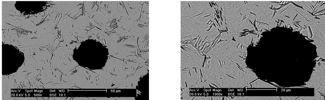
**Figura 4.9** – Micrografias obtidas pelo microscópio eletrônico de varredura para baixo aumento e maior aumento respectivamente das amostras austemperadas por 3 minutos.
