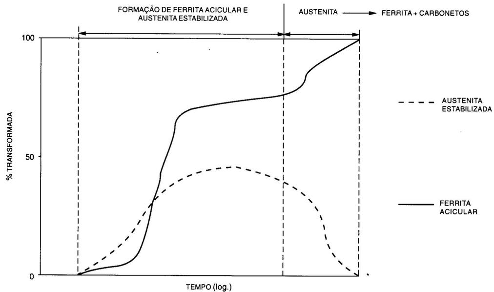
**Figura 2.8** – Transformação da austenita durante a austêmpera do ADI, apresentando os dois estágios da reação de austêmpera [CARMO et al, (2001)]
