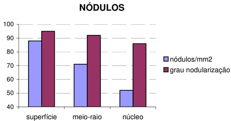
**Figura 4.4** – Grau de nodularização e número de nódulos/mm<sup>2</sup> nas diferentes regiões analisadas.
