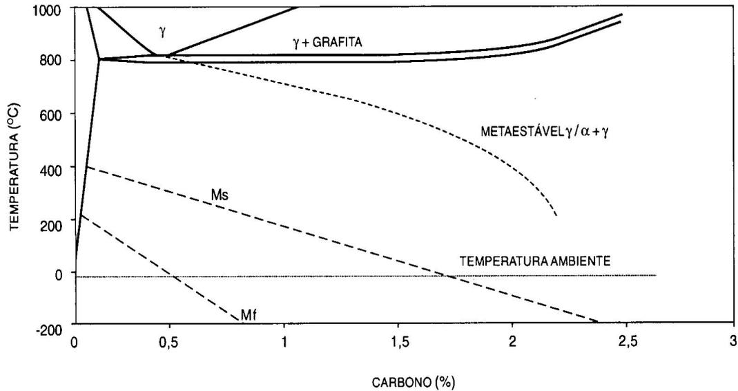
**Figura 2.6** – Diagrama de fases ferro-carbono-silício, mostrando a linha de contorno da reação metaestável e a temperatura de início e fim de transformação martensítica [CARMO et al, (2001)].
