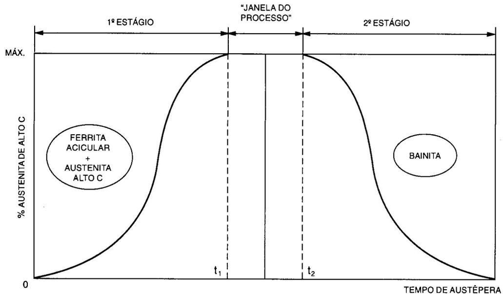
**Figura 2.9** – Representação esquemática da concentração de austenita de alto carbono em função do tempo de austêmpera, apresentando os dois estágios da reação e a “janela de processo” [CARMO et al, (2001)].
