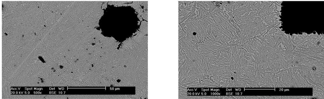
**Figura 4.15** – Micrografias obtidas pelo microscópio eletrônico de varredura para baixo aumento e maior aumento respectivamente das amostras austemperadas por 225 minutos.
