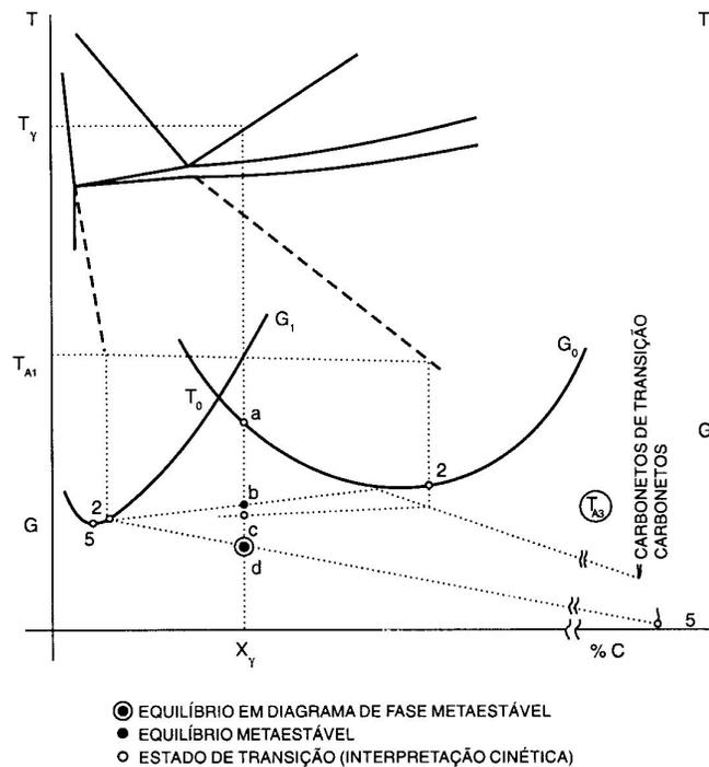
**Figura 2.7** – Seção do diagrama Fe-C, mostrando a reação metaestável e diagramas de energia livre representando o processo de austêmpera [SIKORA et al, 1991].
