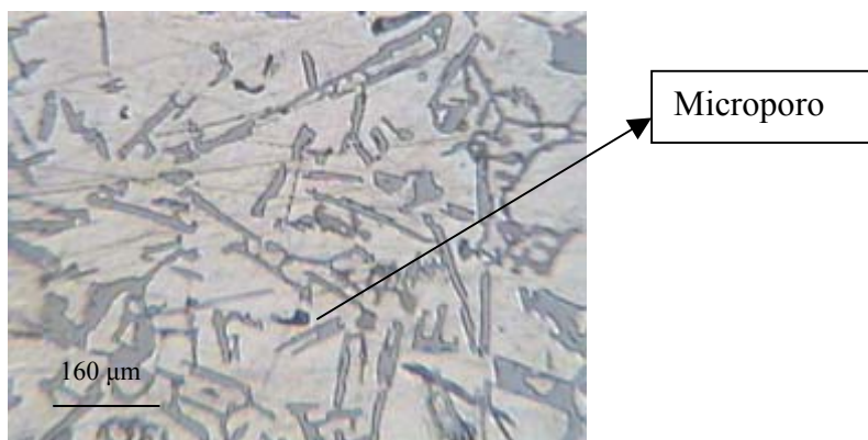
Figura 4.25 – Microestrutura da amostra F1- A3EG, corte B
