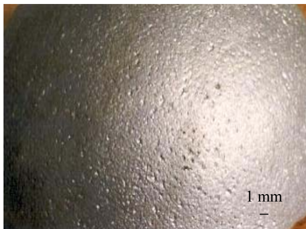
Figura 4.9 – Semi-esfera sem pintura com boa sanidade
