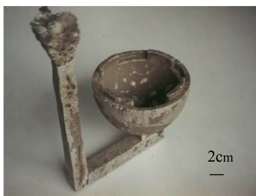
Figura 4.21 – Semi-esfera com bom acabamento, obtida na 3ª série de fusões
