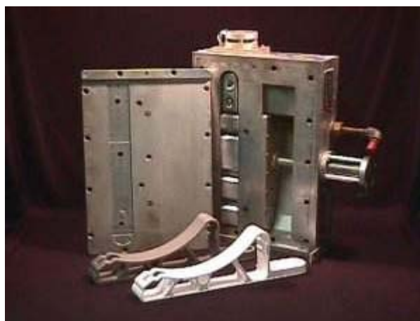
Figura 2.2 – Molde de injeção para poliestireno expansível [2]
