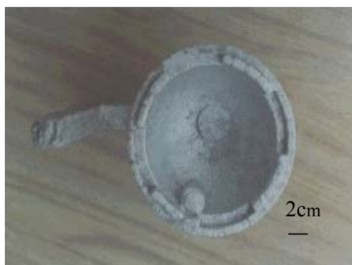
Figura 4.20 – Semi-esfera com bom acabamento, obtida na 2ª série de fusões
