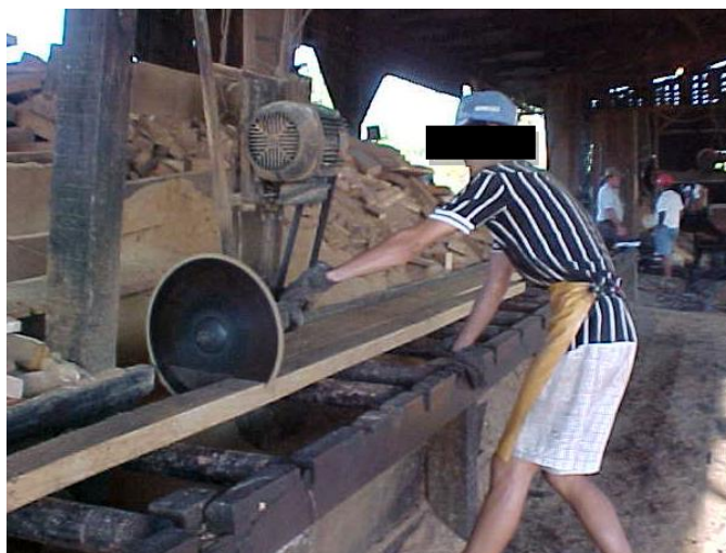
Figura 6 – Destopadeira sem proteção na serra circular e correias e condições inadequadas de trabalho. Sinop/MT, 2000. Fonte: Projeto Vida SFIEMT.
