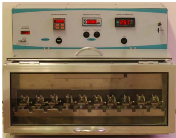
Figura 8– Máquina de escovação: as escovas fixadas alinhadas e paralelas à base; painel digital indicando temperatura, ciclos, velocidade do ciclo, e velocidade da substância injetada
