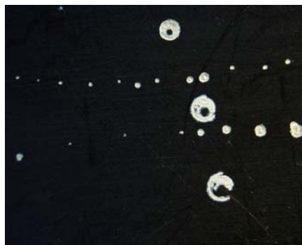
Figura 15: Marcas deixadas pelo feixe do laser em várias posições após incidir no espelho cônico. As marcas maiores apresentam o feixe com o característico orifício no centro, em forma de um donut . Perto da região do foco, o feixe fica com uma distribuição de energia mais homogênea, fechando o orifício no centro.
