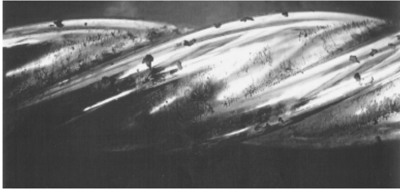
FIGURA 12 – PARTE DO ROTOR QUE MOSTRA A CAMADA DE CROMO DESPRENDIDA DO SUBSTRATO FORMANDO VALES (COBO et al., 1999).
