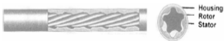
FIGURA 11 – VISÃO ESQUEMÁTICA DO STATOR-ROTOR COM 4 m DE COMPRIMENTO E 8 in DE DIÂMETRO (COBO et al., 1999).
