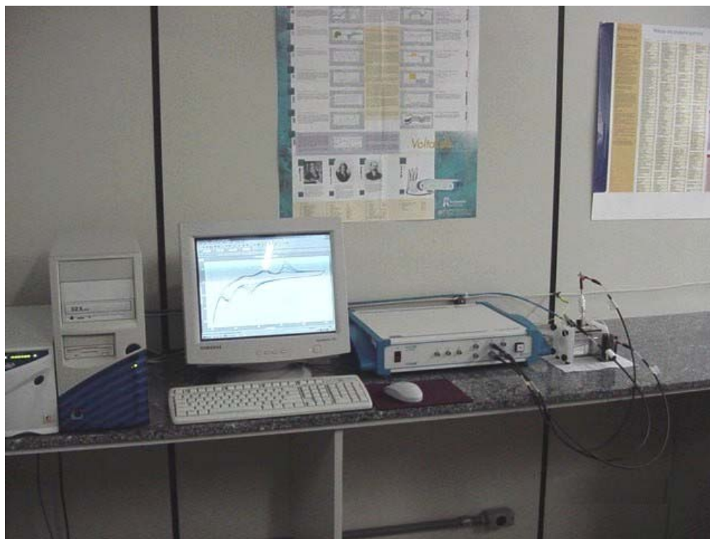
FIGURA 27 – VISÃO GERAL DA BANCADA DE TESTES ELETROQUÍMICOS. DA DIREITA PARA ESQUERDA: CÉLULA DE ELETRODO PLANO, POTENCIOSTATO E MICROCOMPUTADOR.
