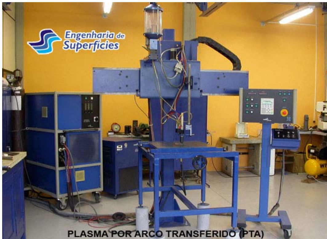
Figura 3.1. Equipamento PTA com alimentação de pó STARWELD 300-Deloro Stellite, instalado no laboratório de Engenharia de Superfícies da UFPR.
