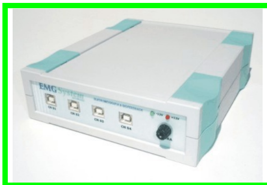
Figura 01: Eletromiográfico EMG400C, usado para o registro da atividade elétrica dos músculos.
