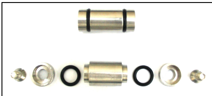
FIGURA 3.3 – FOTOGRAFIA DO PISTÃO UTILIZADO NA CÉLULA DE EQUILÍBRIO FONTE: Ndiaye (2004)
