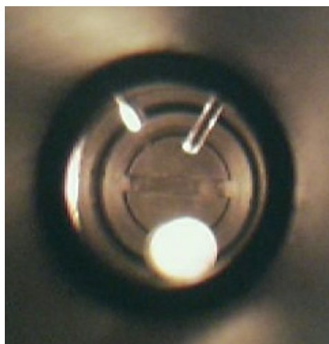
FIGURA 3.7 – VISTA FRONTAL DA CÉLULA MOSTRANDO O POSICIONAMENTO DO TERMOPAR E DA LINHA DE ALIMENTAÇÃO DO SOLVENTE FONTE: Ndyale (2004)
