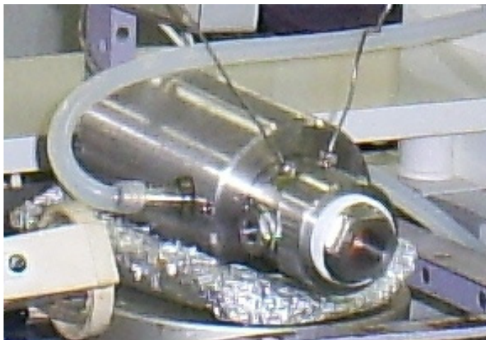
FIGURA 3.2 - FOTOGRAFIA DA CÉLULA DE EQUILÍBRIO CONECTADA A CAMISA DE AQUECIMENTO FONTE: O Autor (2008)
