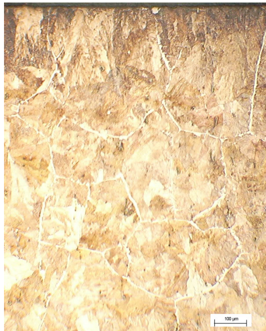
b) FeC 0,45% - Tratamento em plasma catodo aberto – 80% Ar + 20% H 2 - 60 min.
