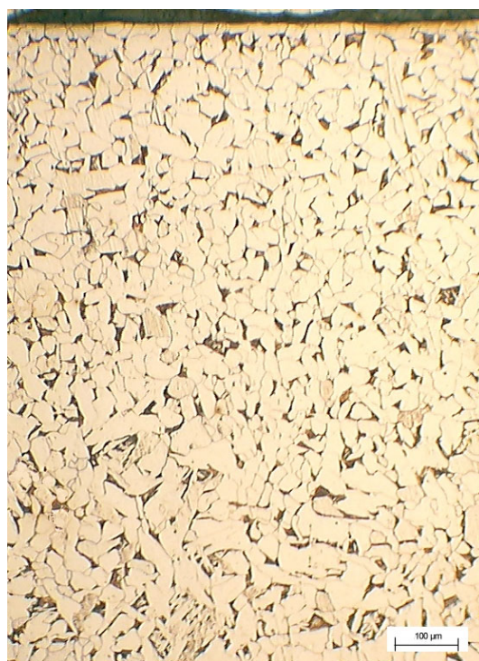
b) Amostra L - FeC 0,2% C - tratada catodo aberto - 665 Pa - 60 min., - 80 % Ar + 20 % H 2 .
