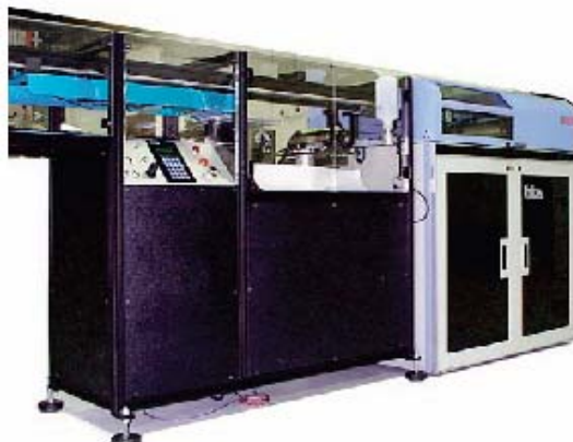
Figura 14. Sistema acoplado LOM e alimentador de tapes utilizado pela Javelin 3D [49].
