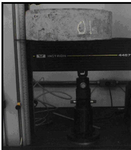
FIGURA 22: ENSAIO PARA DETERMINAÇÃO DA RESISTÊNCIA DE ADERÊNCIA.
