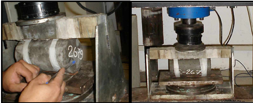
FIGURA 15: FOTOS DO ENSAIO DE RESISTÊNCIA À TRAÇÃO POR COMPRESSÃO DIAMETRAL
