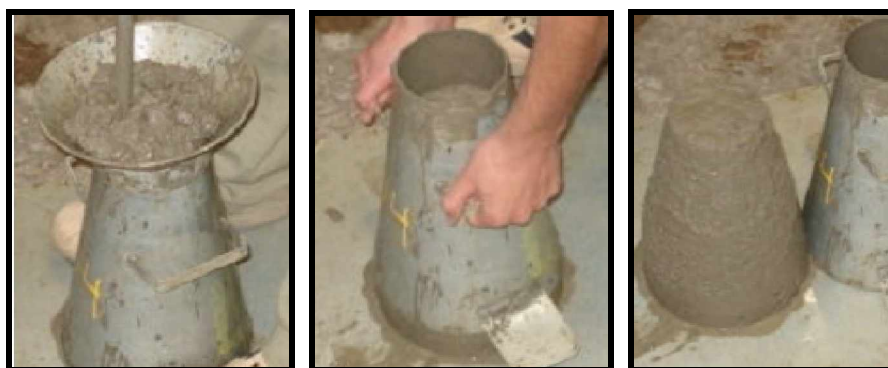
Preenchimento do cone Suspensão lenta do cone Medida de abatimento
