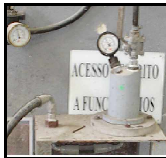
FIGURA 9: EQUIPAMENTO PARA DETERMINAÇÃO DO AR APRISIONADO POR PRESSURIZAÇÃO DO SISTEMA.
