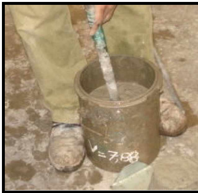
Adensamento do concreto
