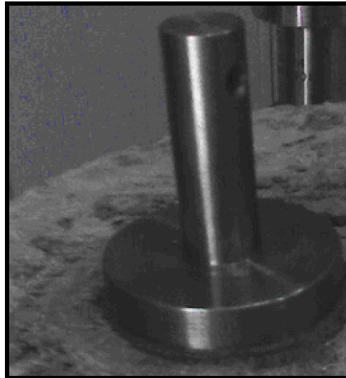
FIGURA 21: COLAGEM DA PLACA METÁLICA SOBRE O MR PARA ENSAIO DE RESISTÊNCIA DE ADERÊNCIA À TRAÇÃO.
