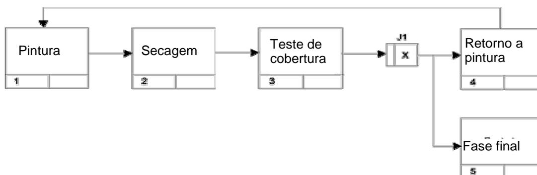
Figura 30 - Diagrama de descrição de Processos do IDEF3.
