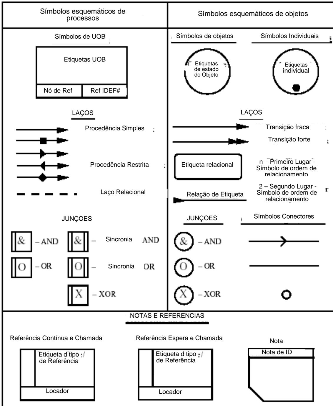
Figura 32 - Símbolos esquemáticos de processos e objetos.
