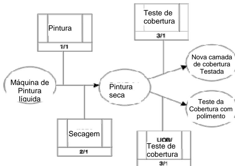
Figura 31 - Diagrama da rede da transição do estado do objeto (OSTM) - IDEF3.
