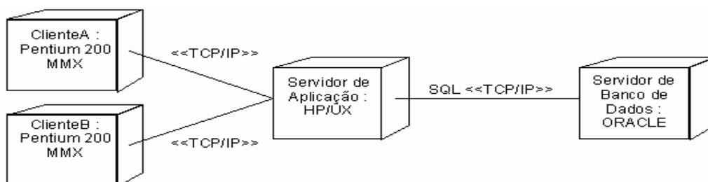
Figura 52 - Diagrama de Execução.
