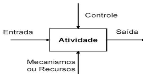
Figura 2 - Um processo em IDEF0 e suas entradas e saídas.
