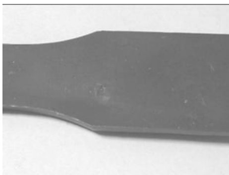
Figura 6.4 – Detalhe do corpo de prova produzido com a amostra B 0 da FP, evidenciando as impurezas não fundidas na superfície do moldado.
