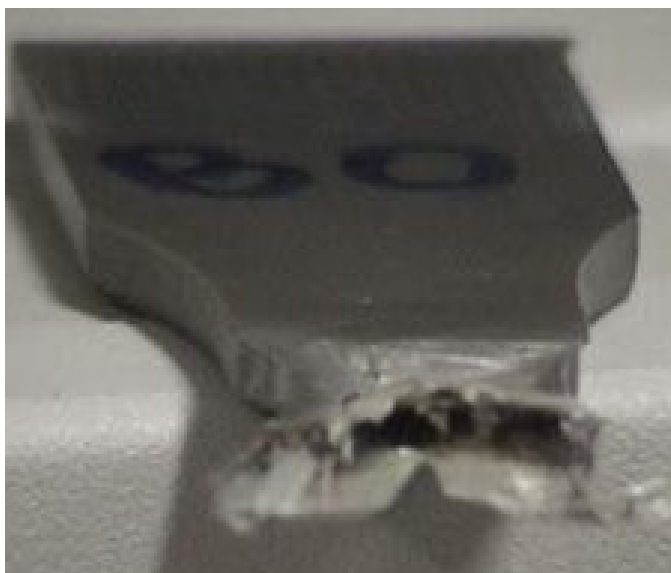
Figura 7.8 – Regiões de vazios internos do corpo de prova da amostra B0 rompido por delaminação.
