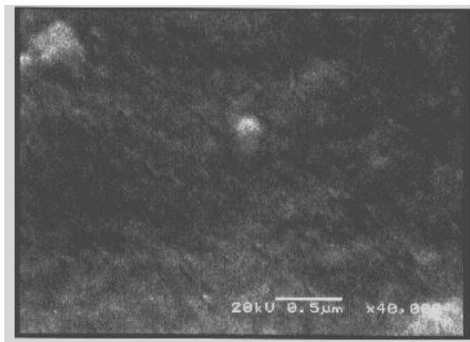
Figura 8.1 - Imagens MEV da resina PP HP1310 fraturadas em N_2 líquido.
