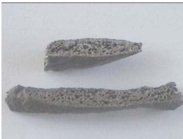
Figura 5.1 - Corte transversal do espagete mostrando a porosidade
