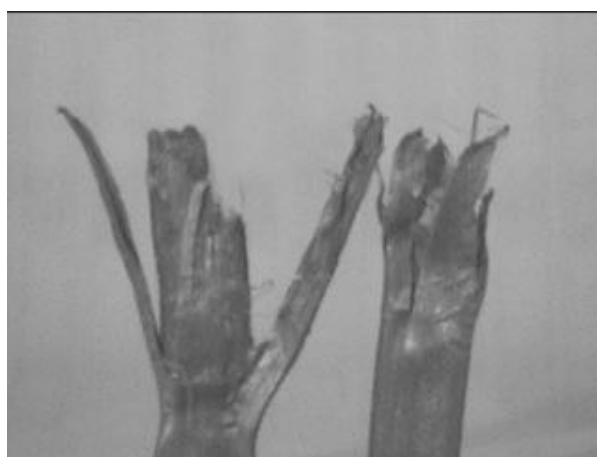
Figura 7.20 - Fotografia de detalhes do corpo de prova da amostra B5 na região de fratura
