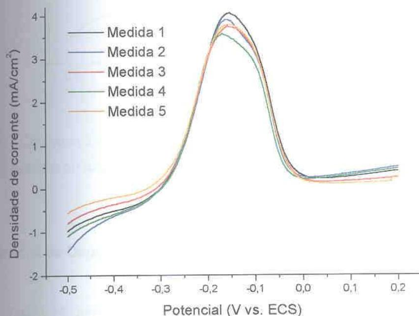
FIGURA 59 – CURVAS DE PASSIVAÇÃO PARA O COBRÉ, POLIMENTO QUÍMICO, SOLUÇÃO: SULFITO DE SÓDIO 50 g/l, VV: 10 mV/s
