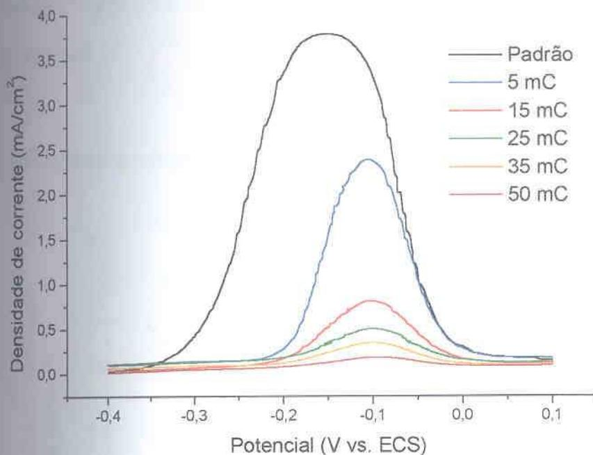
FIGURA 52 – CURVAS DE PASSIVAÇÃO DO COBRE PARA VÁRIAS CARGAS DE DEPOSIÇÃO DE NÍQUEL,  $E_{DEP}$ : -930 mV, POLIMENTO MECÂNICO COM LIXA 600, SOLUÇÃO: SULFITO DE SÓDIO 50 g/l, VV: 10 mV/s
