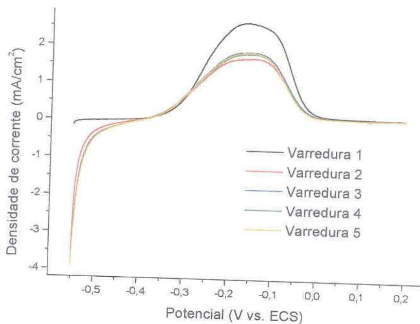
FIGURA 29 – VOLTAMETRIAS DE PASSIVAÇÃO NO SENTIDO ANÓDICO PARA O ELETRODO DE COBRE, TE: 0 s, SOLUÇÃO: SULFITO DE SÓDIO 50 g/l, VV: 10 mV/s
