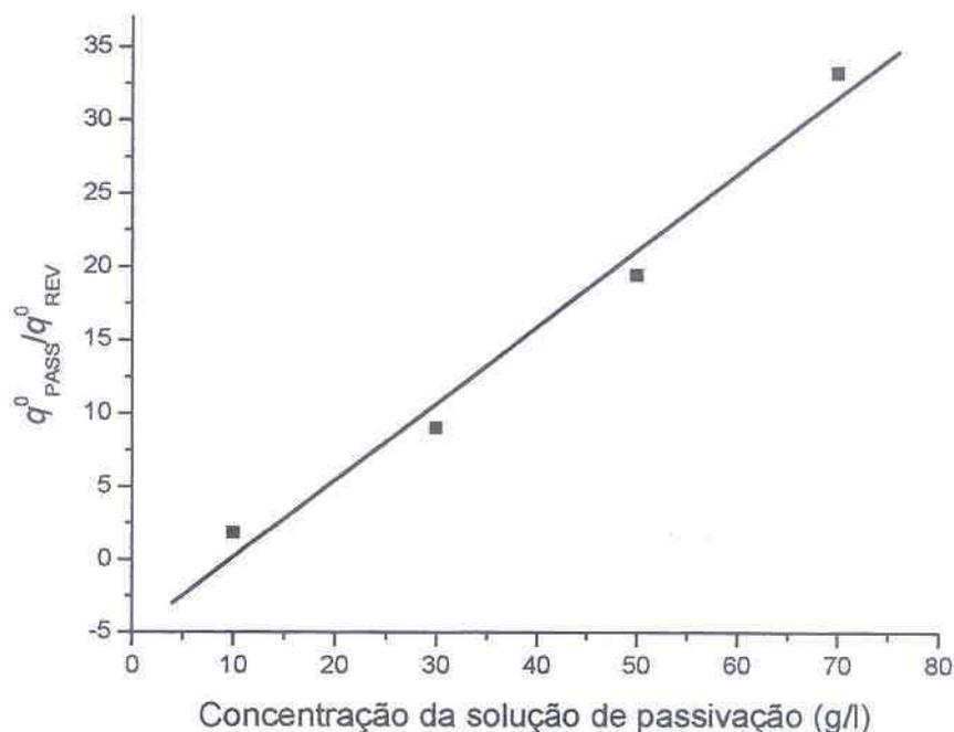
FIGURA 18 – RAZÃO ENTRE AS DENSIDADES DE CARGA DE PASSIVAÇÃO DO COBRE E DO NÍQUEL PARA DIFERENTES CONCENTRAÇÕES DE SULFITO DE SÓDIO
