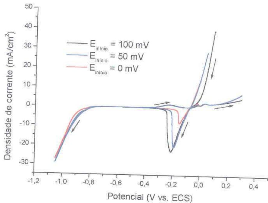
FIGURA 39 – VARIAÇÃO DO PICO DE REDUÇÃO DE COBRE COM O POTENCIAL DE INÍCIO DA VARREDURA CATÓDICA, SOLUÇÃO: BANHO WATTS, VV: 10 mV/s
