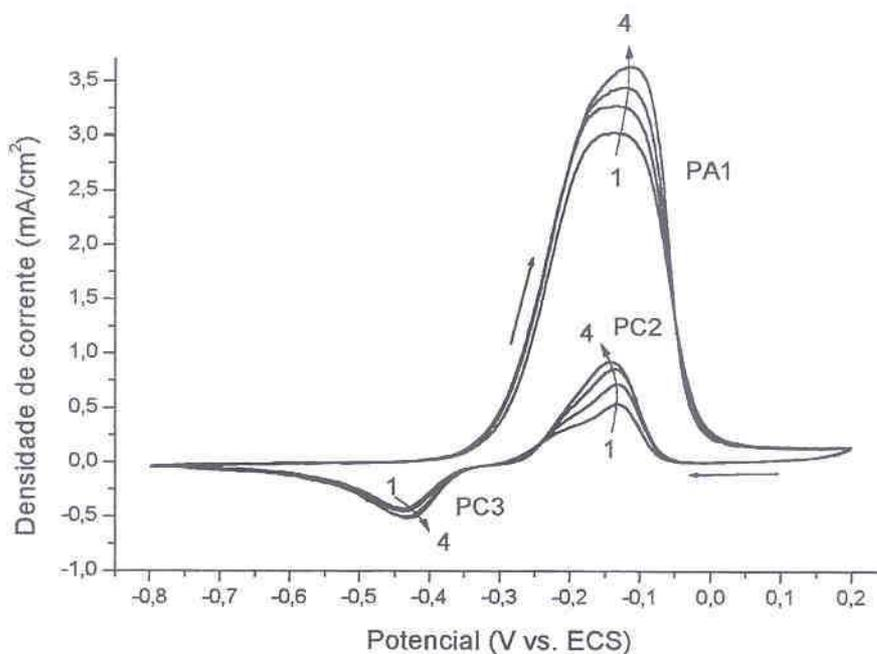
FIGURA 24 – VOLTAMETRIA CÍCLICA PARA O ELETRODO DE COBRE, 4 CICLOS. AS SETAS NUMERADAS INDICAM O DESLOCAMENTO DA CURVA COM OS CICLOS SUBSEQUENTES, SOLUÇÃO: SULFITO DE SÓDIO 50 g/l, VV: 10 mV/s
