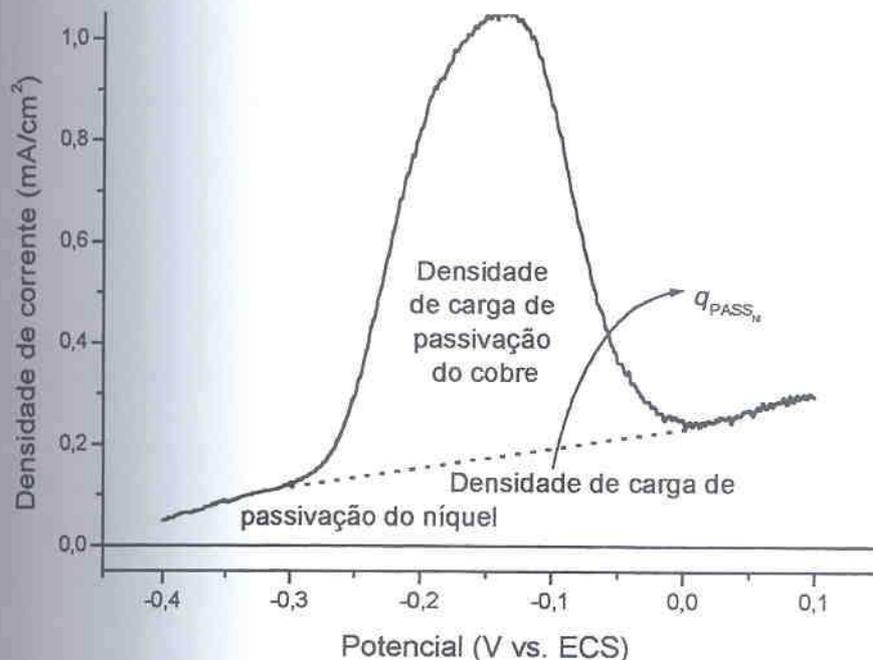
FIGURA 10 – VOLTAMETRIA TÍPICA DE PASSIVAÇÃO PARA UM ELETRODO DE COBRE REVESTIDO. SOLUÇÃO: SULFITO DE SÓDIO 50 g/l, VV: 10 mV/s
