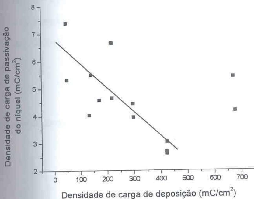
FIGURA 53 – VARIAÇÃO DA DENSIDADE DE CARGA DE PASSIVAÇÃO DO NÍQUEL COM A DENSIDADE DE CARGA DE DEPOSIÇÃO, SUBSTRATO: COBRE,  $E_{DEP}$ : -930 mV, POLIMENTO MECÂNICO COM LIXA 600, SOLUÇÃO: SULFITO DE SÓDIO, 50 g/l, VV: 10 mV/s
