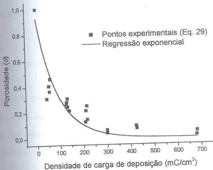
FIGURA 47 – CURVA DE DECAIMENTO DA POROSIDADE VS. DENSIDADE DE CARGA DE DEPOSIÇÃO (EQUAÇÃO 29),  $E_{DEP}$ : -930 mV, POLIMENTO MECÂNICO COM LIXA 2000, SOLUÇÃO: SULFITO DE SÓDIO 50 g/l, VV: 10 mV/s
