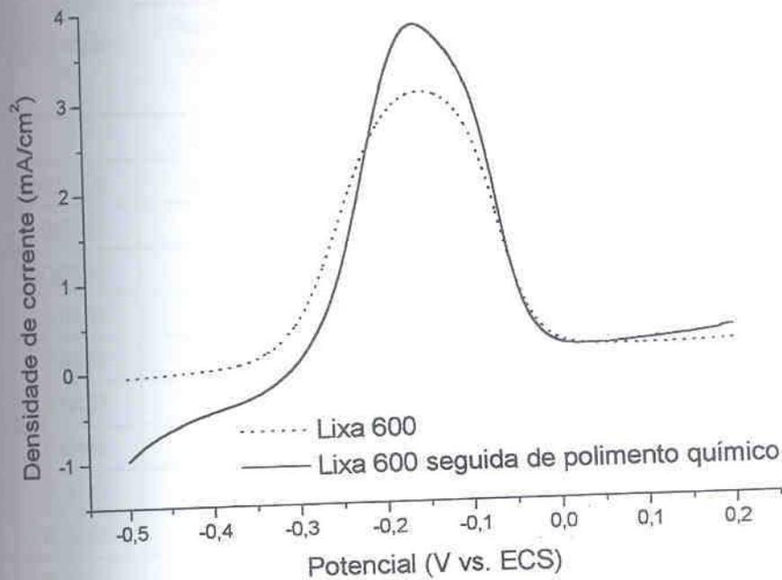
FIGURA 60 – COMPARAÇÃO ENTRE AS CURVAS DE PASSIVAÇÃO PARA O COBRE POLIDO COM LIXA 600 E SEGUIDO OU NÃO DE POLIMENTO QUÍMICO, SOLUÇÃO: SULFITO DE SÓDIO 50 g/l, VV: 10 mV/s
