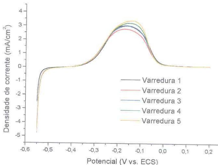
FIGURA 32 – VOLTAMETRIAS DE PASSIVAÇÃO NO SENTIDO ANÓDICO PARA O ELETRODO DE COBRE, TE: 50 s, SOLUÇÃO: SULFITO DE SÓDIO 50 g/l, VV: 10 mV/s
