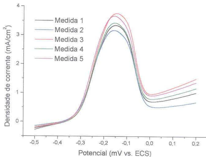
FIGURA 26 – VOLTAMETRIAS PARA O ELETRODO DE COBRE, SOLUÇÃO: SULFITO DE SÓDIO 50 g/l, VR: 0 rpm, VV: 10 mV/s
