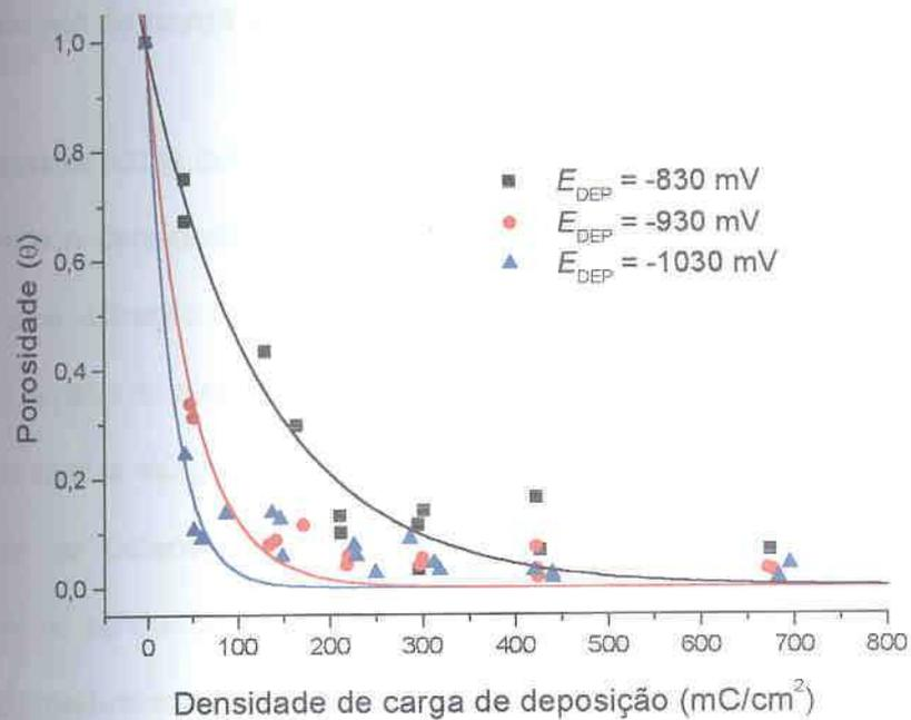
FIGURA 58 – CURVAS DE DECAIMENTO DA POROSIDADE VS. DENSIDADE DE CARGA DE DEPOSIÇÃO, POLIMENTO MECÂNICO COM LIXA 600, SOLUÇÃO: SULFITO DE SÓDIO 50 g/l, VV: 10 mV/s
