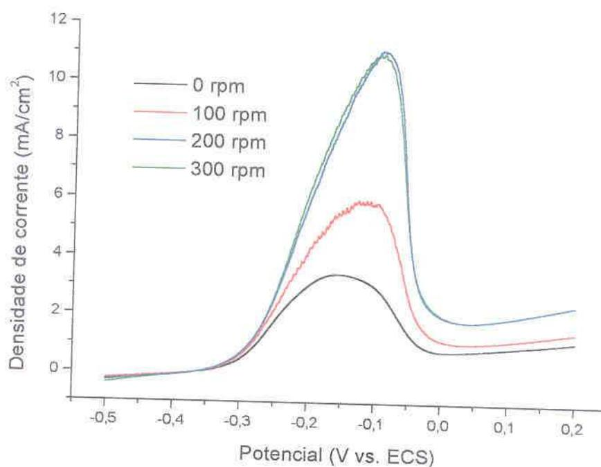
FIGURA 28 – VOLTAMETRIAS PARA O ELETRODO DE COBRE (EDR), SOLUÇÃO: SULFITO DE SÓDIO 50 g/l, VV: 10 mV/s, VR: 0, 100, 200 E 300 rpm
