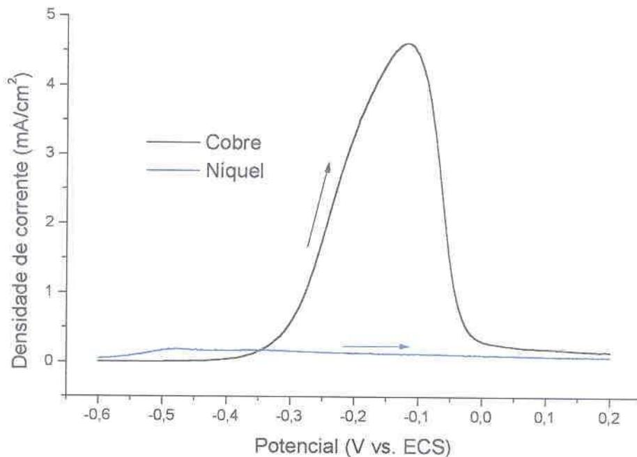
FIGURA 14 – VOLTAMETRIAS PARA OS ELETRODOS DE TRABALHO DE COBRE E DE NÍQUEL,
