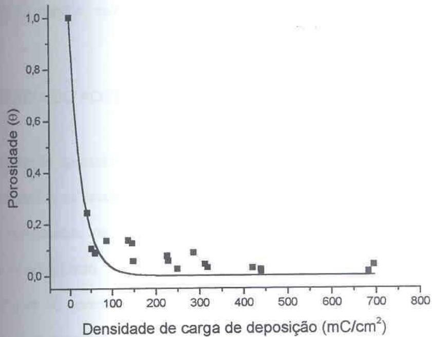
FIGURA 57 – CURVA DE DECAIMENTO DA POROSIDADE VS. DENSIDADE DE CARGA DE DEPOSIÇÃO,  $E_{DEP}$ : -1030 mV, POLIMENTO MECÂNICO COM LIXA 600, SOLUÇÃO: SULFITO DE SÓDIO 50 g/l, VV: 10 mV/s
