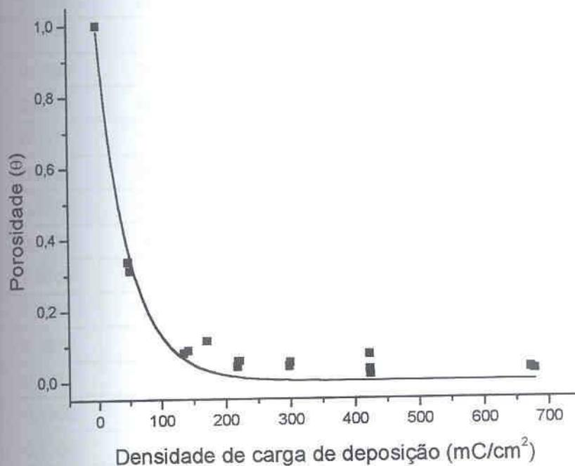
FIGURA 54 – CURVA DE DECAIMENTO DA POROSIDADE VS. DENSIDADE DE CARGA DE DEPOSIÇÃO,  $E_{DEP}$ : -930 mV, POLIMENTO MECÂNICO COM LIXA 600, SOLUÇÃO: SULFITO DE SÓDIO 50 g/l, VV: 10 mV/s
