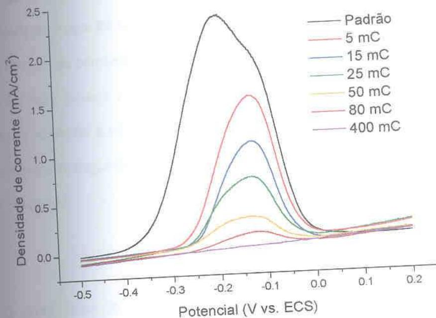
FIGURA 45 – CURVAS DE PASSIVAÇÃO DO COBRE PARA VÁRIAS CARGAS DE DEPOSIÇÃO DE NÍQUEL,  $E_{DEP}$ : -930 mV, POLIMENTO MECÂNICO COM LIXA 2000, SOLUÇÃO: SULFITO DE SÓDIO 50 g/l, VV: 10 mV/s
