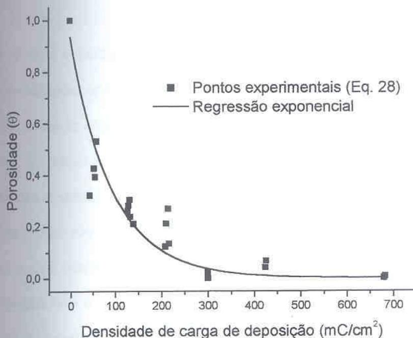
FIGURA 48 – CURVA DE DECAIMENTO DA POROSIDADE VS. DENSIDADE DE CARGA DE DEPOSIÇÃO (EQUAÇÃO 28),  $E_{DEP}$ : -930 mV, POLIMENTO MECÂNICO COM LIXA 2000, SOLUÇÃO: SULFITO DE SÓDIO 50 g/l, VV: 10 mV/s
