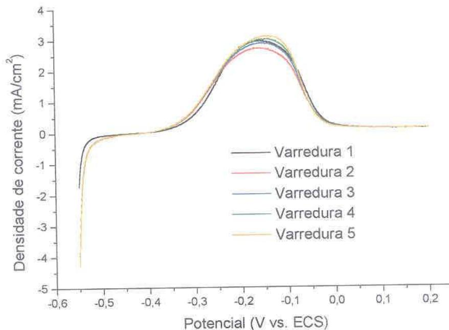
FIGURA 31 – VOLTAMETRIAS DE PASSIVAÇÃO NO SENTIDO ANÓDICO PARA O ELETRODO DE COBRE, TE: 20 s, SOLUÇÃO: SULFITO DE SÓDIO 50 g/l, VV: 10 mV/s
