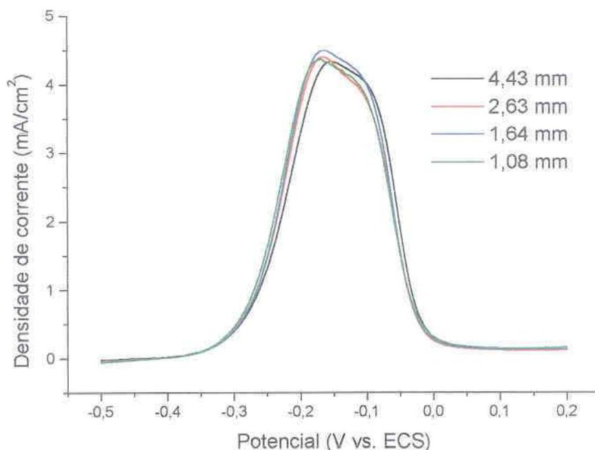
FIGURA 37 – COMPARAÇÃO ENTRE DENSIDADE DE CARGA PADRÃO DE PASSIVAÇÃO PARA O COBRE, DIÂMETRO DO ELETRODO 4,43 mm, 2,63 mm, 1,64 mm E 1,08 mm, SOLUÇÃO: SULFITO DE SÓDIO 50 g/l, VV: 10 mV/s
