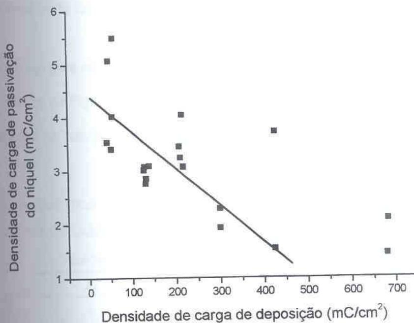
FIGURA 46 – VARIAÇÃO DA DENSIDADE DE CARGA DE PASSIVAÇÃO DO NÍQUEL COM A DENSIDADE DE CARGA DE DEPOSIÇÃO, SUBSTRATO: COBRE,  $E_{DEP}$ : -930 mV, POLIMENTO MECÂNICO COM LIXA 2000, SOLUÇÃO: SULFITO DE SÓDIO, 50 g/l, VV: 10 mV/s
