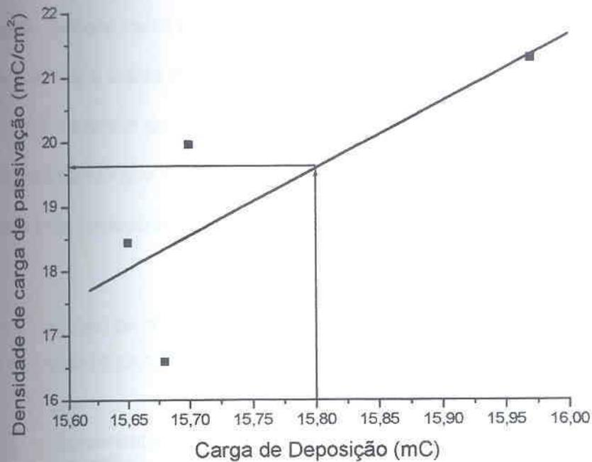
FIGURA 67 – DENSIDADE DE CARGA DE PASSIVAÇÃO VS. CARGA DE DEPOSIÇÃO,  $E_{DEP}$ : -930 mV, POLIMENTO MECÂNICO COM LIXA 600, SOLUÇÃO: SULFITO DE SÓDIO 50 g/l, VV: 10 mV/s
