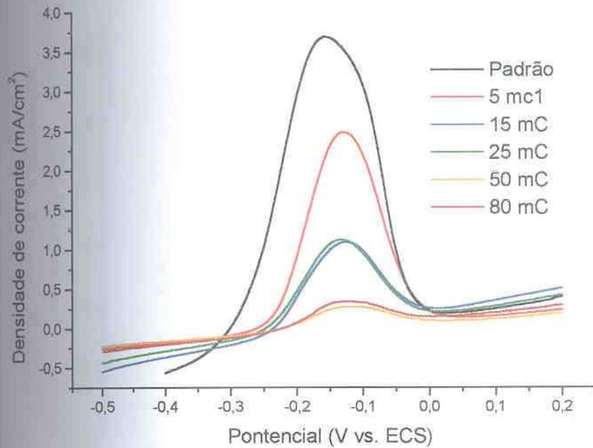
FIGURA 61 – CURVAS DE PASSIVAÇÃO DO COBRE PARA VÁRIAS CARGAS DE DEPOSIÇÃO DE NÍQUEL,  $E_{DEP}$ : -930 mV, POLIMENTO QUÍMICO, SOLUÇÃO: SULFITO DE SÓDIO 50 g/l, VV: 10 mV/s
