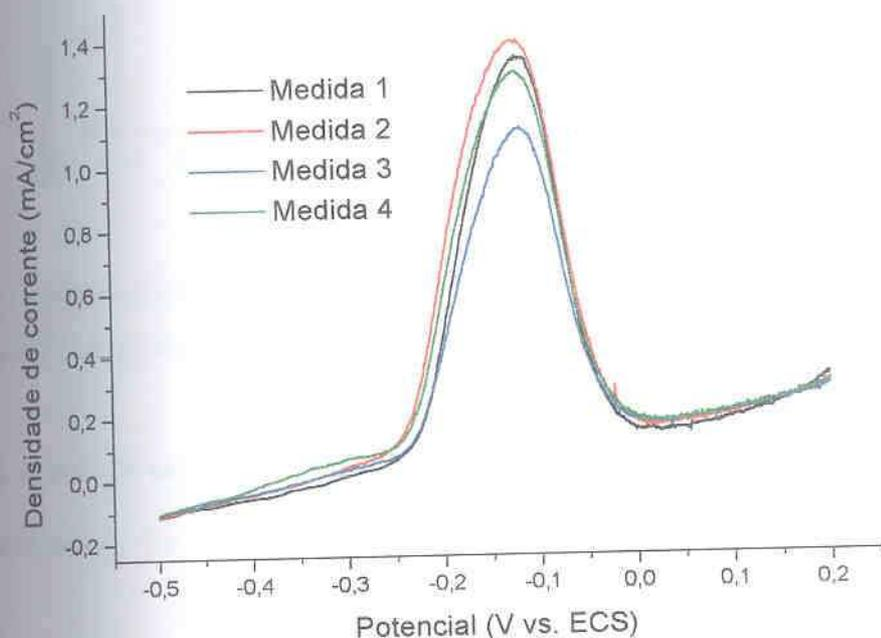
FIGURA 66 – CURVAS DE PASSIVAÇÃO DO COBRE, DENSIDADE DE CARGA DE DEPOSIÇÃO  $132,8 \text{ mC/cm}^2$ ,  $E_{\text{DEP}}: -930 \text{ mV}$ , POLIMENTO MECÂNICO COM LIXA 600, SOLUÇÃO: SULFITO DE SÓDIO  $50 \text{ g/l}$ , VV:  $10 \text{ mV/s}$
