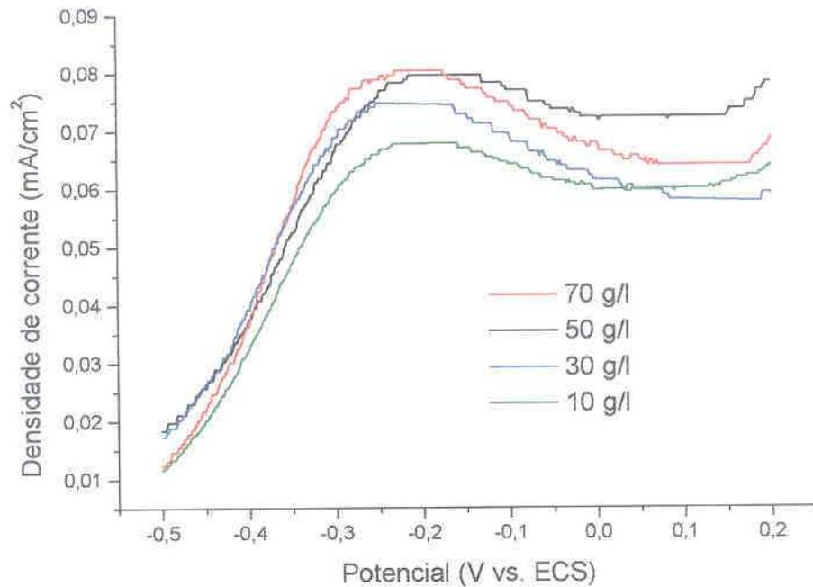
FIGURA 16 – CURVAS DE DISSOLUÇÃO/PASSIVAÇÃO PARA O NÍQUEL (EN), SOLUÇÃO: SULFITO DE SÓDIO, VV: 10 mV/s, CONCENTRAÇÕES: 10, 30, 50 E 70 g/l,
