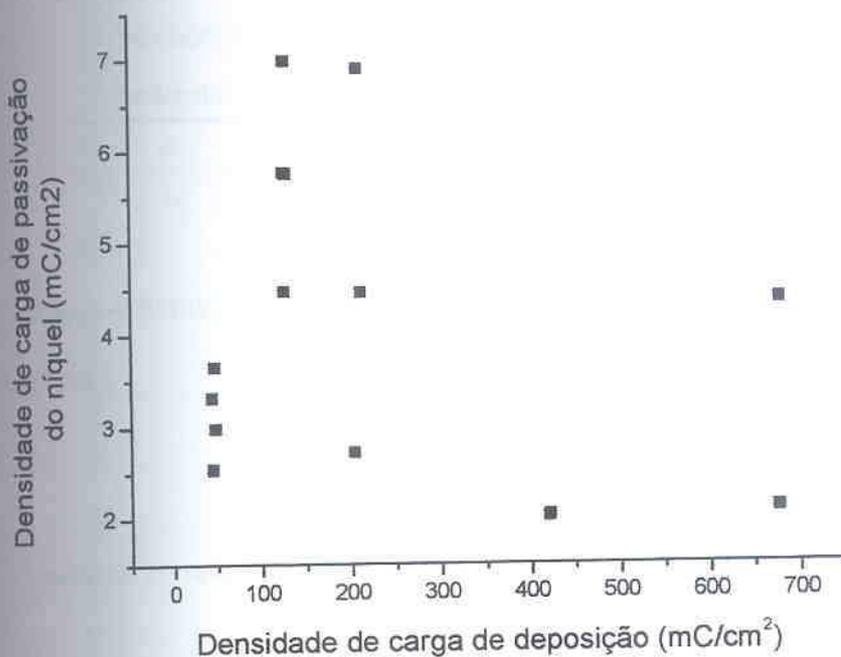
FIGURA 62 – VARIAÇÃO DA DENSIDADE DE CARGA DE PASSIVAÇÃO DO NÍQUEL COM A DENSIDADE DE CARGA DE DEPOSIÇÃO, SUBSTRATO: COBRE,  $E_{DEP}$ : -930 mV, POLIMENTO QUÍMICO, SOLUÇÃO: SULFITO DE SÓDIO, 50 g/l, VV: 10 mV/s
