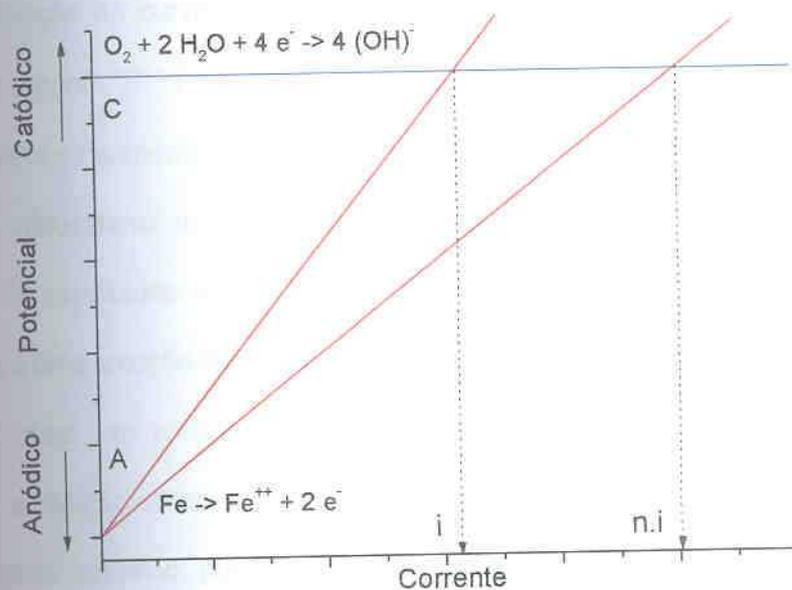
FIGURA 7 – REPRESENTAÇÃO ESQUEMÁTICA SIMPLIFICADA DAS CURVAS ANÓDICA E CATÓDICA EM UM ELETRÓLITO CORROSIVO <sup>(7)</sup>
