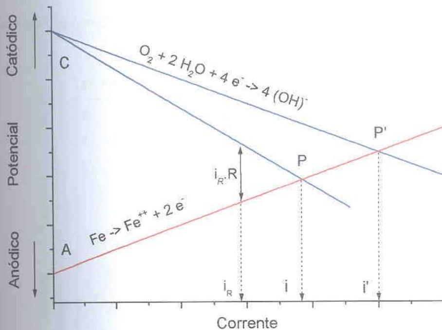
FIGURA 6 – REPRESENTAÇÃO ESQUEMÁTICA SIMPLIFICADA DAS CURVAS ANÓDICA E CATÓDICA EM UM ELETRÓLITO CORROSIVO<sup>(7)</sup>
