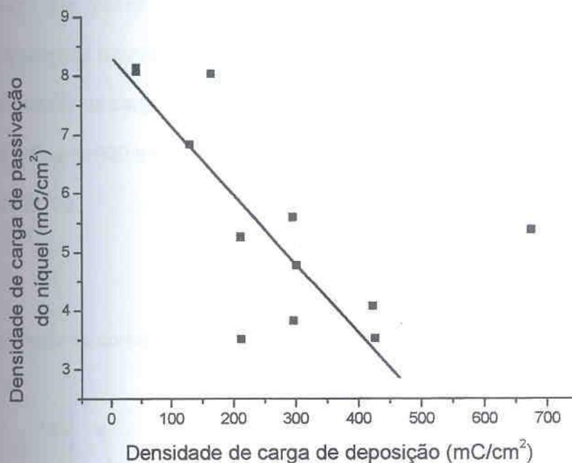
FIGURA 50 – VARIACÃO DA DENSIDADE DE CARGA DE PASSIVAÇÃO DO NÍQUEL COM A DENSIDADE DE CARGA DE DEPOSIÇÃO, SUBSTRATO: COBRE,  $E_{DEP}$ : -830 mV, POLIMENTO MECÂNICO COM LIXA 600, SOLUÇÃO: SULFITO DE SÓDIO, 50 g/l, VV: 10 mV/s
