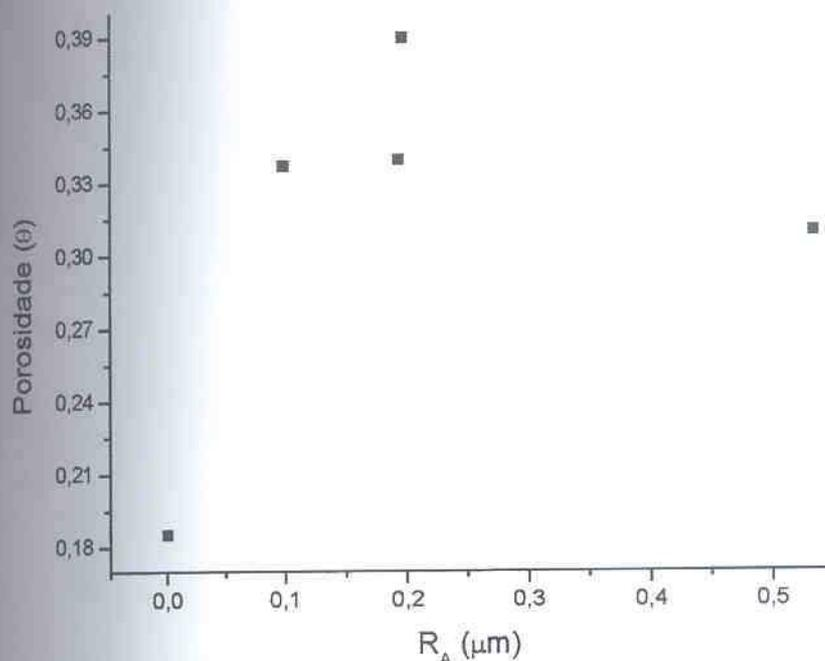
FIGURA 68 – VARIÇÃO DA POROSIDADE (EQUAÇÃO 29) COM A RUGOSIDADE SUPERFICIAL,  $Q_{\text{DEP}}$ : 132,8 mC/cm<sup>2</sup>,  $E_{\text{DEP}}$ : -930 mV, POLIMENTO QUÍMICO E POLIMENTO MECÂNICO COM LIXAS 600, 1000, 1500 E 2000, SOLUÇÃO: SULFITO DE SÓDIO 50 g/l, VV: 10 mV/s
