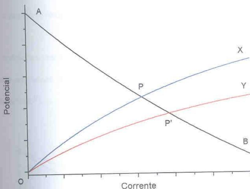
FIGURA 5 – RELAÇÕES SIMPLIFICADAS ENTRE O POTENCIAL E A ÁREA DO SUBSTRATO EXPOSTA ATRAVÉS DOS POROS DO REVESTIMENTO, VÁLIDAS QUANDO O REVESTIMENTO É CATÓDICO EM RELAÇÃO AO SUBSTRATO<sup>(21)</sup>
