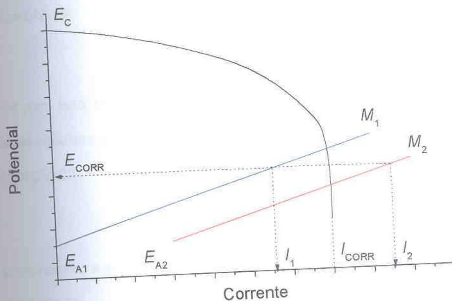
FIGURA 8 – DIAGRAMA DE POLARIZAÇÃO MOSTRANDO O EFEITO DA JUNÇÃO DE DOIS METAIS DIFERENTES SOBRE A TAXA DE CORROSÃO<sup>(46)</sup>
