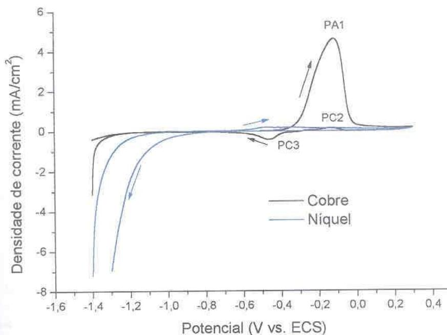
FIGURA 13 – VOLTAMETRIAS PARA OS ELETRODOS DE TRABALHO DE COBRE E DE NÍQUEL, POTENCIAL DE REVERSÃO: 300 mV, SOLUÇÃO: SULFITO DE SÓDIO 50 g/l, VV: 10 mV/s
