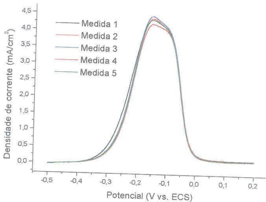
FIGURA 36 – CURVAS DE PASSIVAÇÃO PARA O COBRE, DIÂMETRO: 4,43 mm, SOLUÇÃO: SULFITO DE SÓDIO 50 g/l, VV: 10 mV/s
