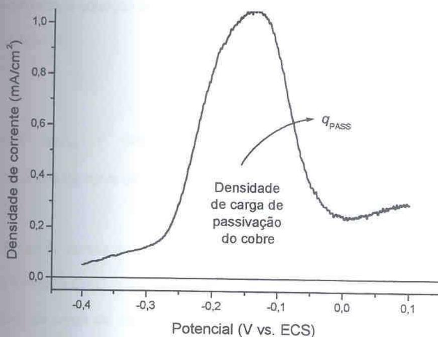
FIGURA 9 – VOLTAMETRIA TÍPICA DE PASSIVAÇÃO PARA UM ELETRODO DE COBRE REVESTIDO COM NÍQUEL, SOLUÇÃO: SULFITO DE SÓDIO 50 g/l, VV: 10 mV/s
