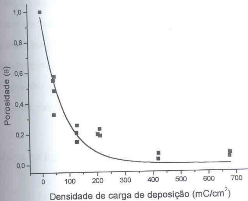
FIGURA 63 – CURVA DE DECAIMENTO DA POROSIDADE VS. DENSIDADE DE CARGA DE DEPOSIÇÃO,  $E_{DEP}$ : -930 mV, POLIMENTO QUÍMICO, SOLUÇÃO: SULFITO DE SÓDIO 50 g/l, VV: 10 mV/s
