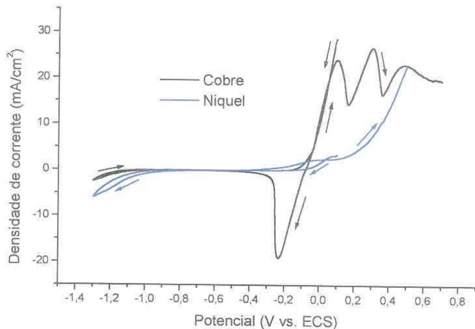
FIGURA 40 – VOLTAMETRIAS PARA OS ELETRODOS DE COBRE E NÍQUEL, SOLUÇÃO: BRANCO 2,
