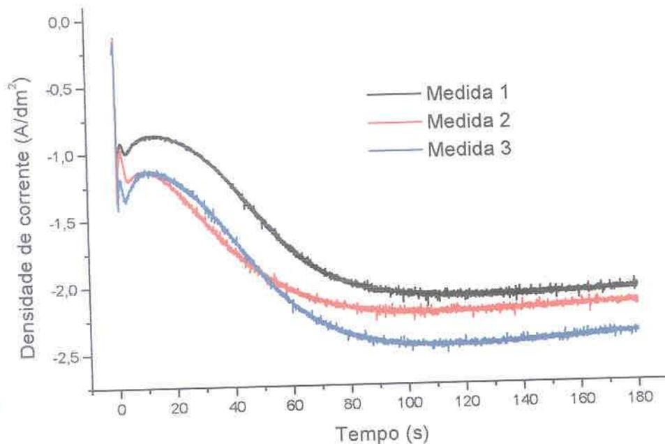
FIGURA 43 – VARIAÇÃO DA CORRENTE DE DEPOSIÇÃO COM O TEMPO PARA A DEPOSIÇÃO DE NÍQUEL SOBRE COBRE,  $E_{DEP}$ : -830 mV, SOLUÇÃO: BANHO WATTS
