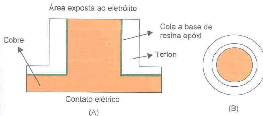
FIGURA 11 – DESENHO ESQUEMÁTICO DAS PONTEIRAS DE COBRE, (A) CORTE LONGITUDINAL, (B) VISTA SUPERIOR
