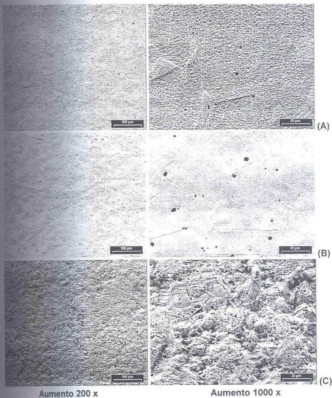
FIGURA 69 – ASPECTO SUPERFICIAL DO COBRE APÓS POLIMENTO QUÍMICO (VER SEÇÃO 6.7),
