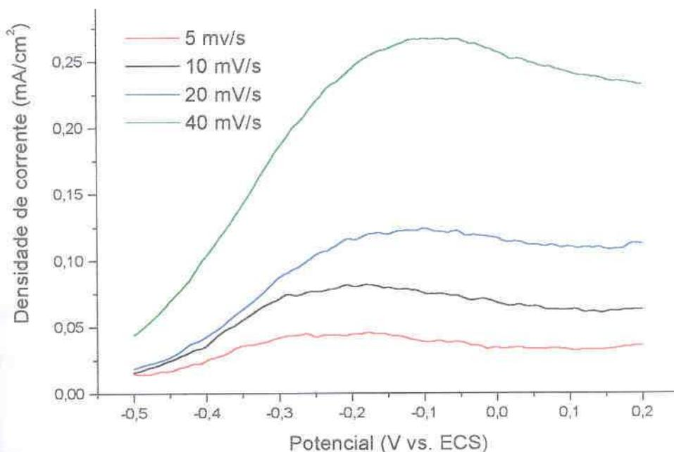
FIGURA 22 – COMPARAÇÃO DAS VOLTAMETRIAS DE DISSOLUÇÃO PARA O NÍQUEL (EN), SOLUÇÃO: SULFITO DE SÓDIO 50 g/l, VV: 5, 10, 20 E 40 mV/s
