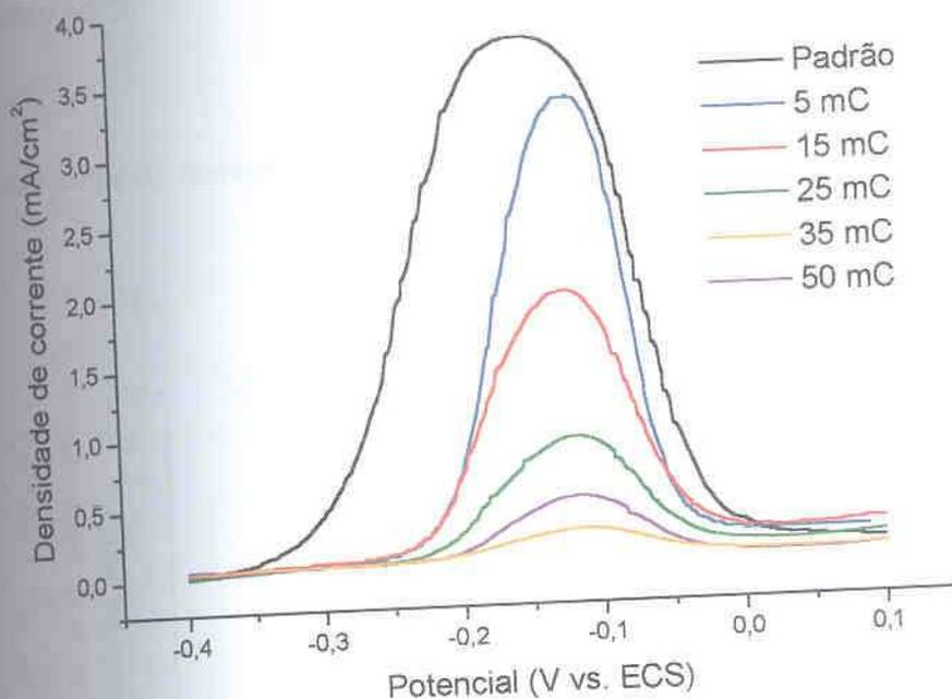
FIGURA 49 – CURVAS DE PASSIVAÇÃO DO COBRE PARA VÁRIAS CARGAS DE DEPOSIÇÃO DE NÍQUEL,  $E_{\text{DEP}}$ : -830 mV, POLIMENTO MECÂNICO COM LIXA 600, SOLUÇÃO: SULFITO DE SÓDIO 50 g/l, VV: 10 mV/s
