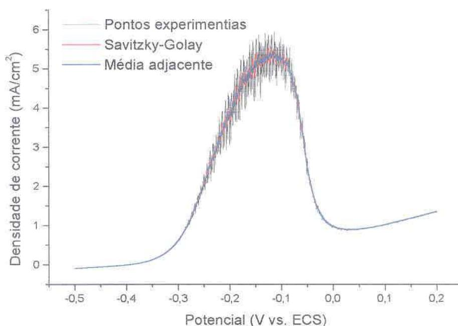
FIGURA 27 – COMPARAÇÃO DOS MÉTODOS DE SUAVIZAÇÃO UTILIZADOS PARA AS MEDIDAS COM ELETRODO DE DISCO ROTATÓRIO (EDR), SOLUÇÃO: SULFITO DE SÓDIO 50 g/l, VV: 10 mV/s, VR: 100 rpm
