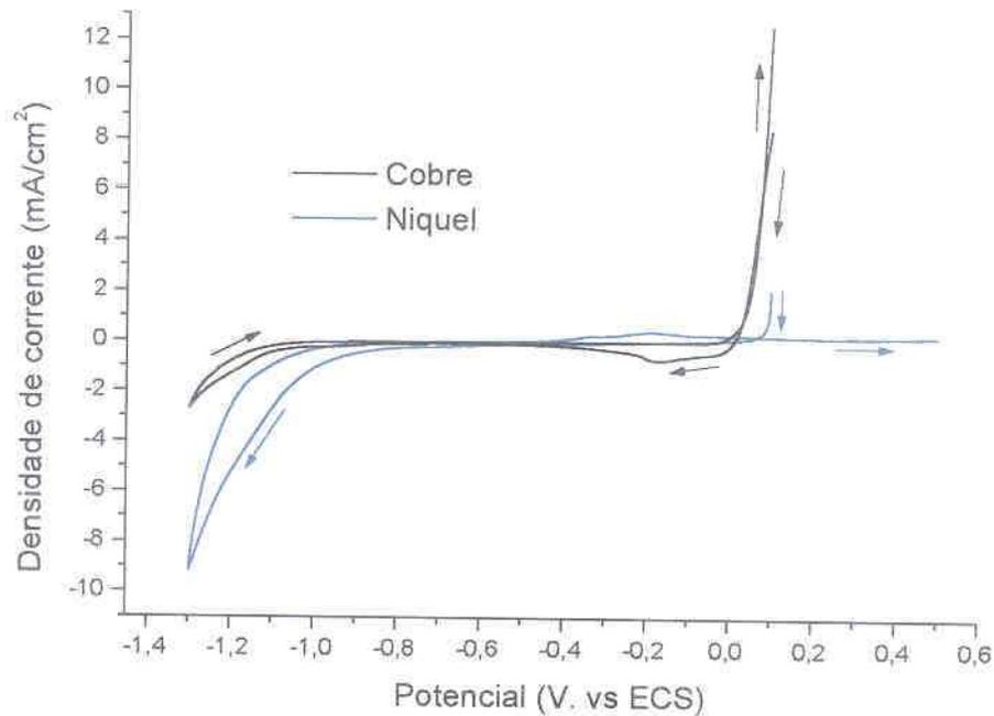
FIGURA 42 – VOLTAMETRIAS PARA OS ELETRODOS DE COBRE E NÍQUEL, SOLUÇÃO: BRANCO 3, VV: 10 mV/s
