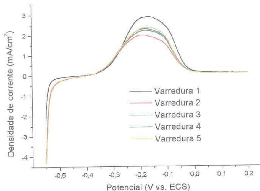
FIGURA 30 – VOLTAMETRIAS DE PASSIVAÇÃO NO SENTIDO ANÓDICO PARA O ELETRODO DE COBRE, TE: 5 s, SOLUÇÃO: SULFITO DE SÓDIO 50 g/l, VV: 10 mV/s
