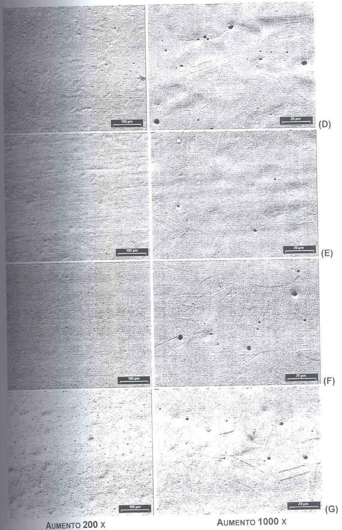
FIGURA 70 – ASPECTO SUPERFICIAL DO COBRE APÓS POLIMENTO QUÍMICO (VER SEÇÃO 6.7),
