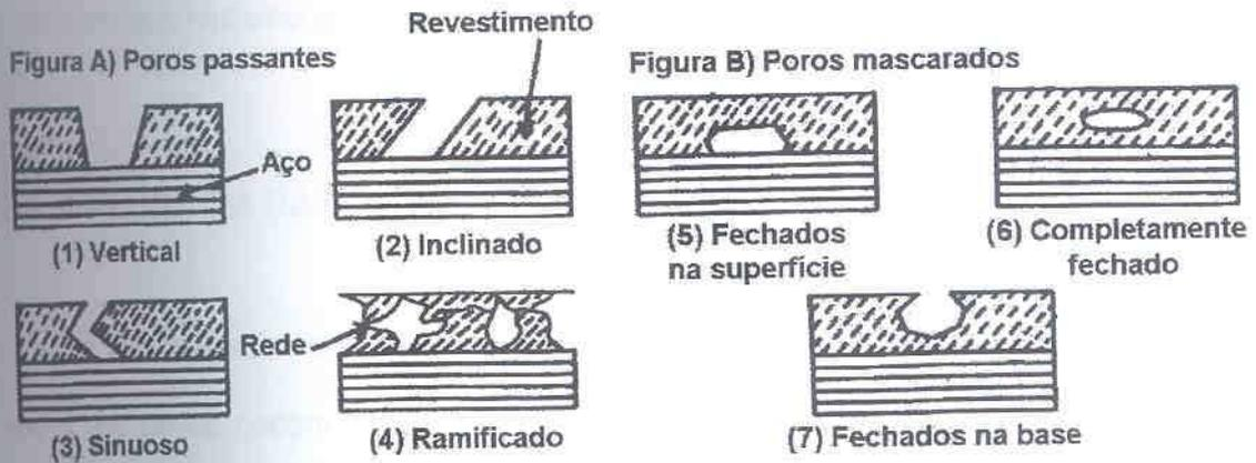
FIGURA 2 – TIPOS DE POROS (ADAPTADO DE NAHLE ET AL., 1998)
