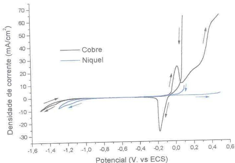
FIGURA 41 – VOLTAMETRIAS PARA OS ELETRODOS DE COBRE E NÍQUEL, SOLUÇÃO: BRANCO 4, VV: 10 mV/s
