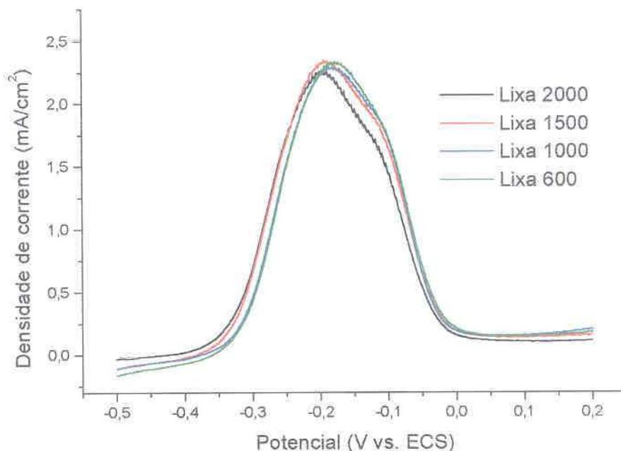
FIGURA 35 – COMPARAÇÃO ENTRE DENSIDADE DE CARGA PADRÃO DE PASSIVAÇÃO PARA O COBRE, POLIMENTO MECÂNICO COM LIXAS 600, 1000, 1500 E 2000, SOLUÇÃO: SULFITO DE SÓDIO 50 g/l, VV: 10 mV/s
