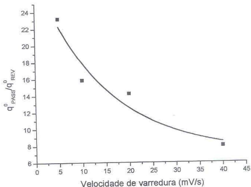
FIGURA 23 – RAZÃO ENTRE AS DENSIDADES DE CARGA DE PASSIVAÇÃO DO COBRE E DO NÍQUEL, SOLUÇÃO: SULFITO DE SÓDIO 50 g/l, VV: 5, 10, 20 E 40 mV/s
