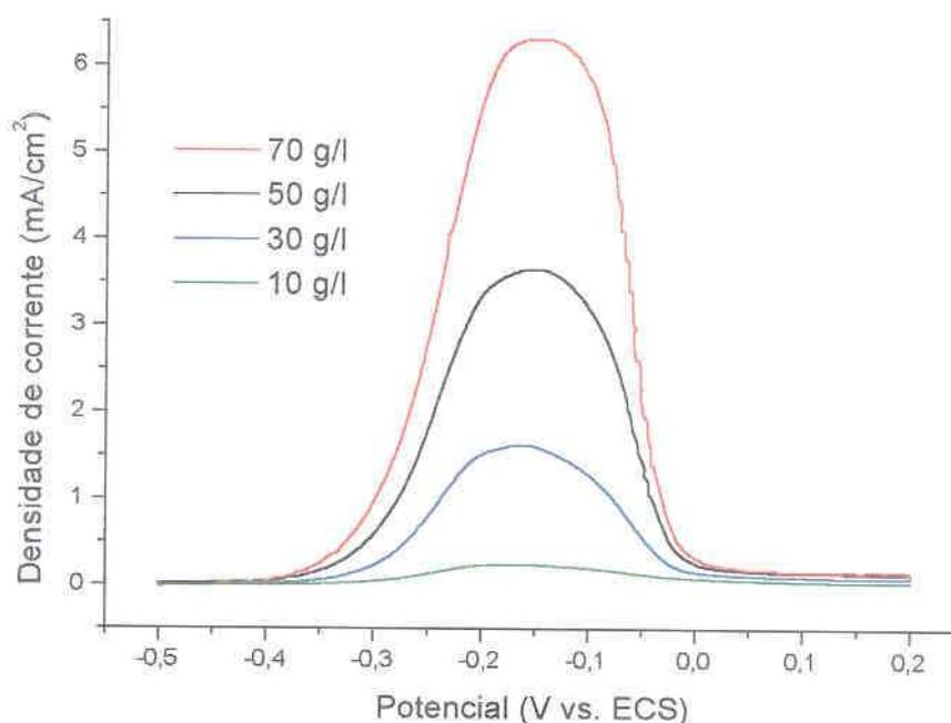
FIGURA 15 – CURVAS DE PASSIVAÇÃO PARA O COBRE (ECM), SOLUÇÃO: SULFITO DE SÓDIO, VV: 10 mV/s, CONCENTRAÇÕES DE 10, 30, 50 E 70 g/l
