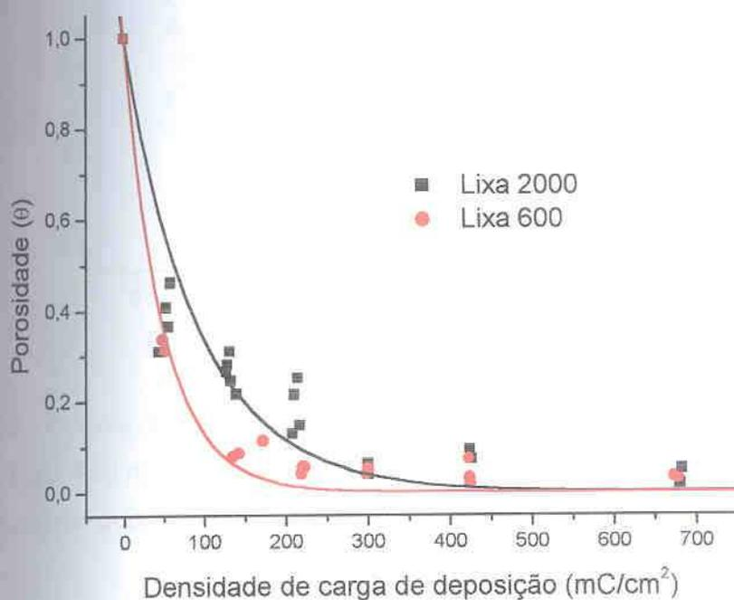
FIGURA 64 – CURVAS DE DECAIMENTO DA POROSIDADE VS. DENSIDADE DE CARGA DE DEPOSIÇÃO,  $E_{\text{DEP}}$ : -930 mV, COMPARAÇÃO ENTRE POLIMENTO MECÂNICO COM LIXA 2000 E LIXA 600, SOLUÇÃO: SULFITO DE SÓDIO 50 g/l, VV: 10 mV/s
