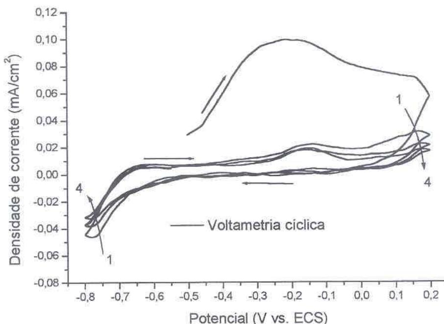
FIGURA 25 – VOLTAMETRIA CÍCLICA PARA O ELETRODO DE NÍQUEL, 4 CICLOS. AS SETAS NUMERADAS INDICAM O DESLOCAMENTO DA CURVA COM OS CICLOS SUBSEQUENTES, SOLUÇÃO: SULFITO DE SÓDIO 50 g/l, VV: 10 mV/s
