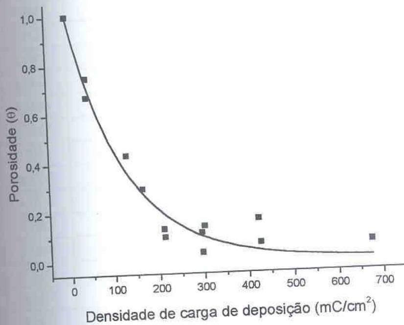
FIGURA 51 – CURVA DE DECAIMENTO DA POROSIDADE VS. DENSIDADE DE CARGA DE DEPOSIÇÃO,  $E_{DEP}$ : -830 mV, POLIMENTO MECÂNICO COM LIXA 600, SOLUÇÃO: SULFITO DE SÓDIO 50 g/l, VV: 10 mV/s
