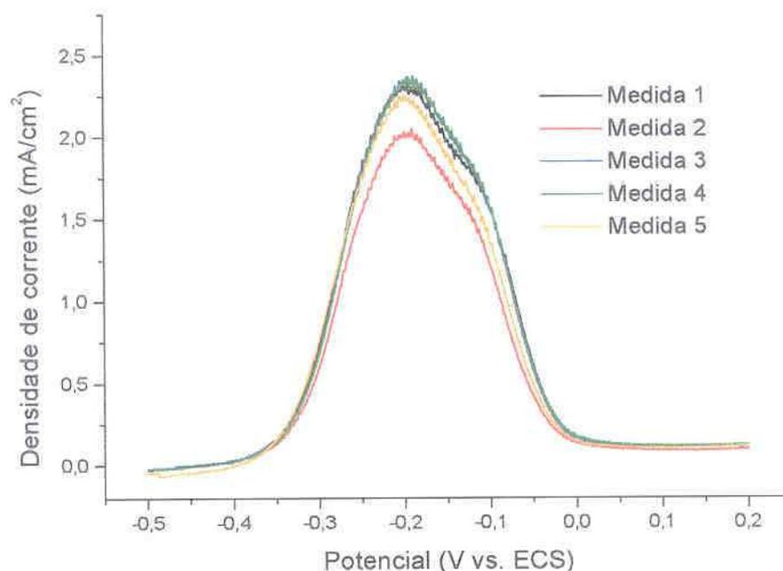
FIGURA 34 – DENSIDADE DE CARGA PADRÃO DE PASSIVAÇÃO PARA O COBRE, POLIMENTO MECÂNICO COM LIXA 2000, SOLUÇÃO: SULFITO DE SÓDIO 50 g/l, VV: 10 mV/s
