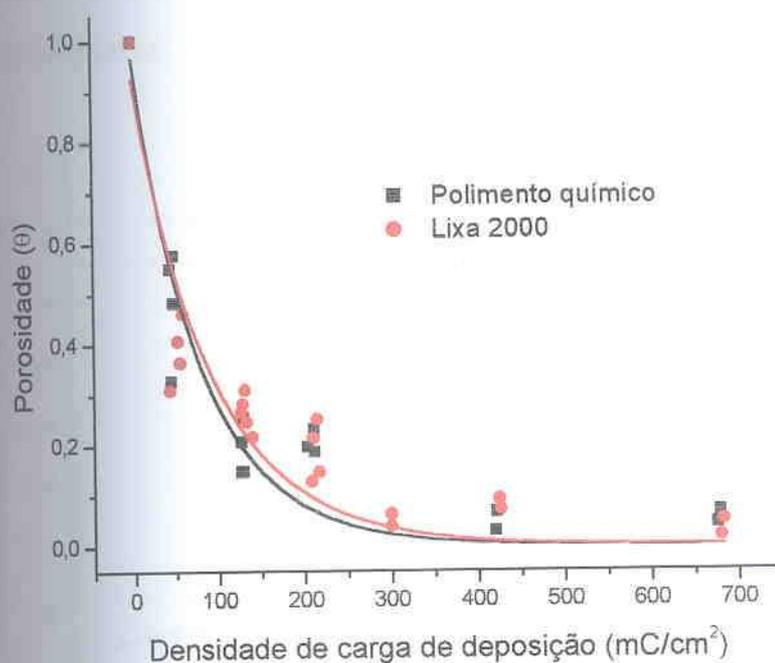
FIGURA 65 – CURVAS DE DECAIMENTO DA POROSIDADE VS. DENSIDADE DE CARGA DE DEPOSIÇÃO,  $E_{DEP}$ : -930 mV, COMPARAÇÃO ENTRE POLIMENTO MECÂNICO COM LIXA 2000 E POLIMENTO QUÍMICO, SOLUÇÃO: SULFITO DE SÓDIO 50 g/l, VV: 10 mV/s
