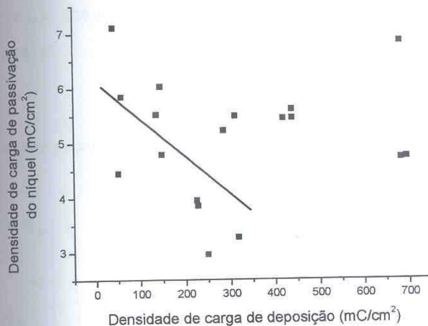
FIGURA 56 – VARIACÃO DA DENSIDADE DE CARGA DE PASSIVAÇÃO DO NÍQUEL COM A DENSIDADE DE CARGA DE DEPOSIÇÃO, SUBSTRATO: COBRE,  $E_{DEP}$ : -1030 mV, POLIMENTO MECÂNICO COM LIXA 600, SOLUÇÃO: SULFITO DE SÓDIO, 50 g/l, VV: 10 mV/s
