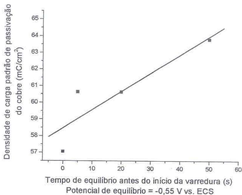
FIGURA 33 – VARIÇÃO DA DENSIDADE DE CARGA PADRÃO DE PASSIVAÇÃO DO COBRE (VARREDURA 1) COM O TEMPO DE EQUILÍBRIO ANTES DO INÍCIO DA VARREDURA NO SENTIDO ANÓDICO, SOLUÇÃO: SULFITO DE SÓDIO 50 g/l, VV: 10 mV/s
