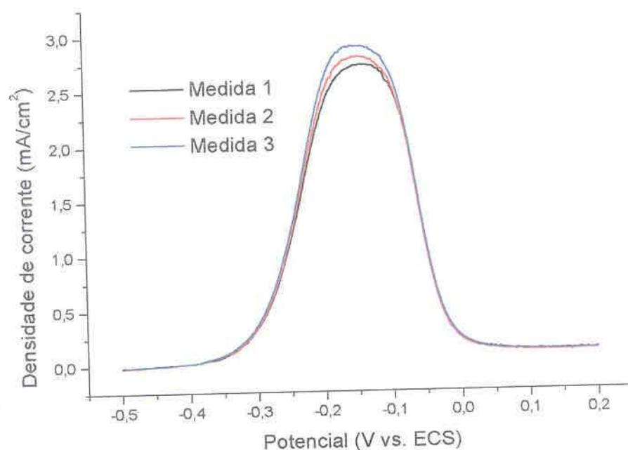
FIGURA 19 – VOLTAMETRIAS DE DISSOLUÇÃO/PASSIVAÇÃO PARA O COBRE (ECM), SOLUÇÃO: SULFITO DE SÓDIO 50 g/l, VV: 10 mV/s
