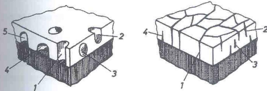
FIGURA 1 – REPRESENTAÇÃO ESQUEMÁTICA DOS DIFERENTES TIPOS DE POROS E TRINCAS. TIPO 1: PORO/TRINCA PASSANTE, TIPO 2: PORO/TRINCA ABERTO NÃO-PASSANTE, TIPO 3: PORO/TRINCA FECHADO, RESTRITO INTEIRAMENTE NO REVESTIMENTO, TIPO 4 E 5: POROS/TRINCAS FECHADOS, CONTÍGUO E PENETRANTE NO SUBSTRATO, RESPECTIVAMENTE. COM PERMISSÃO DO AUTOR.
