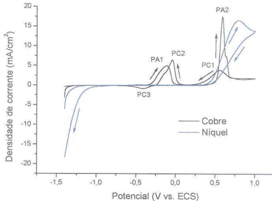
FIGURA 12 – VOLTAMETRIAS PARA OS ELETRODOS DE TRABALHO DE COBRE (ECM) E DE NÍQUEL (EN), POTENCIAL DE REVERSÃO: 1000 mV, SOLUÇÃO: SULFITO DE SÓDIO 50 g/l, VV: 10 mV/s
