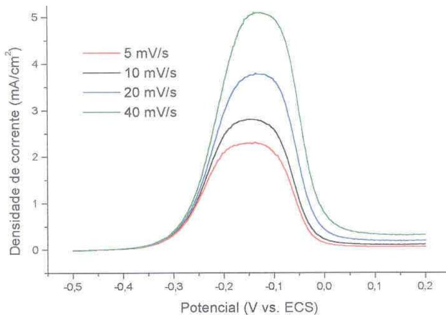
FIGURA 21 – COMPARAÇÃO DAS VOLTAMETRIAS DE DISSOLUÇÃO/PASSIVAÇÃO PARA O COBRE (ECM), SOLUÇÃO: SULFITO DE SÓDIO 50 g/l, VV: 5, 10, 20 E 40 mV/s
