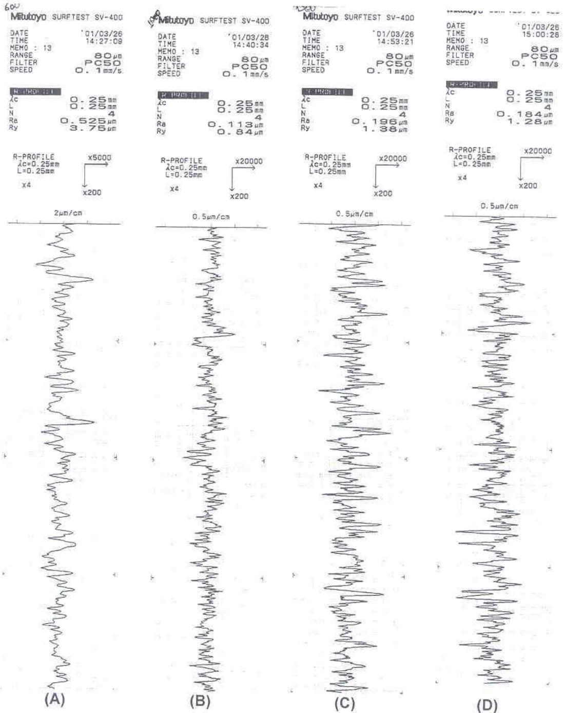
FIGURA 85 – PERFIL DE RUGOSIDADE PARA AS PONTEIRAS DE COBRE, POLIMENTO MECÂNICO: (A) LIXA 600, (B) LIXA 1000, (C) LIXA 1500 E (D) LIXA 2000
