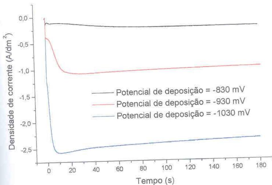
FIGURA 44 – CURVAS DA VARIAÇÃO DA DENSIDADE DE CORRENTE COM TEMPO PARA O PROCESSO DE DEPOSIÇÃO POTENCIOSTÁTICA DE NÍQUEL A POTENCIAIS DISTINTOS, SOLUÇÃO: BANHO WATTS
