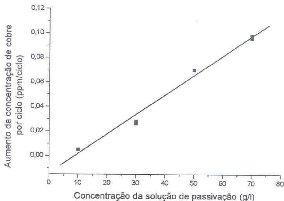
FIGURA 17 – AUMENTO DA CONCENTRAÇÃO DE COBRE EM SOLUÇÃO POR CICLO (VOLTAMETRIA) PARA DIFERENTES CONCENTRAÇÕES DE SULFITO DE SÓDIO
