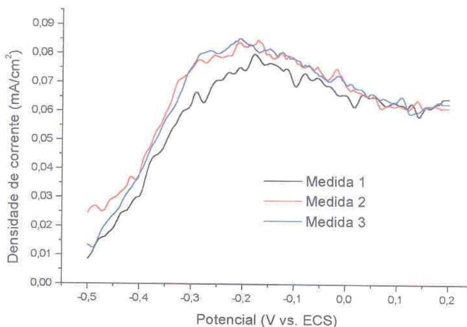
FIGURA 20 – VOLTAMETRIAS DE DISSOLUÇÃO/PASSIVAÇÃO PARA O NÍQUEL (EN), SOLUÇÃO: SULFATO DE SÓDIO 50 g/l, VV: 10 mV/s
