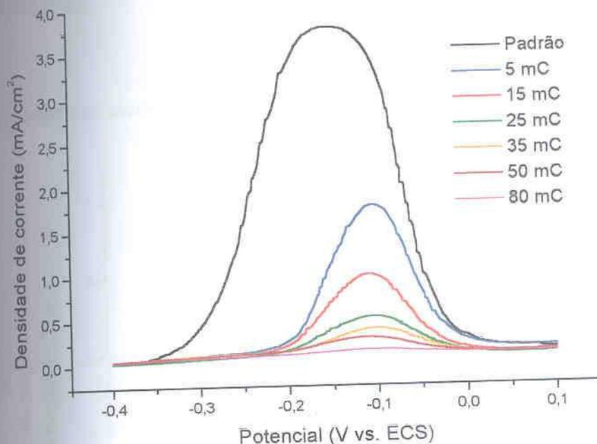
FIGURA 55 – CURVAS DE PASSIVAÇÃO DO COBRE PARA VÁRIAS CARGAS DE DEPOSIÇÃO DE NÍQUEL,  $E_{DEP}$ : -1030 mV, POLIMENTO MECÂNICO COM LIXA 600, SOLUÇÃO: SULFITO DE SÓDIO 50 g/l, VV: 10 mV/s
