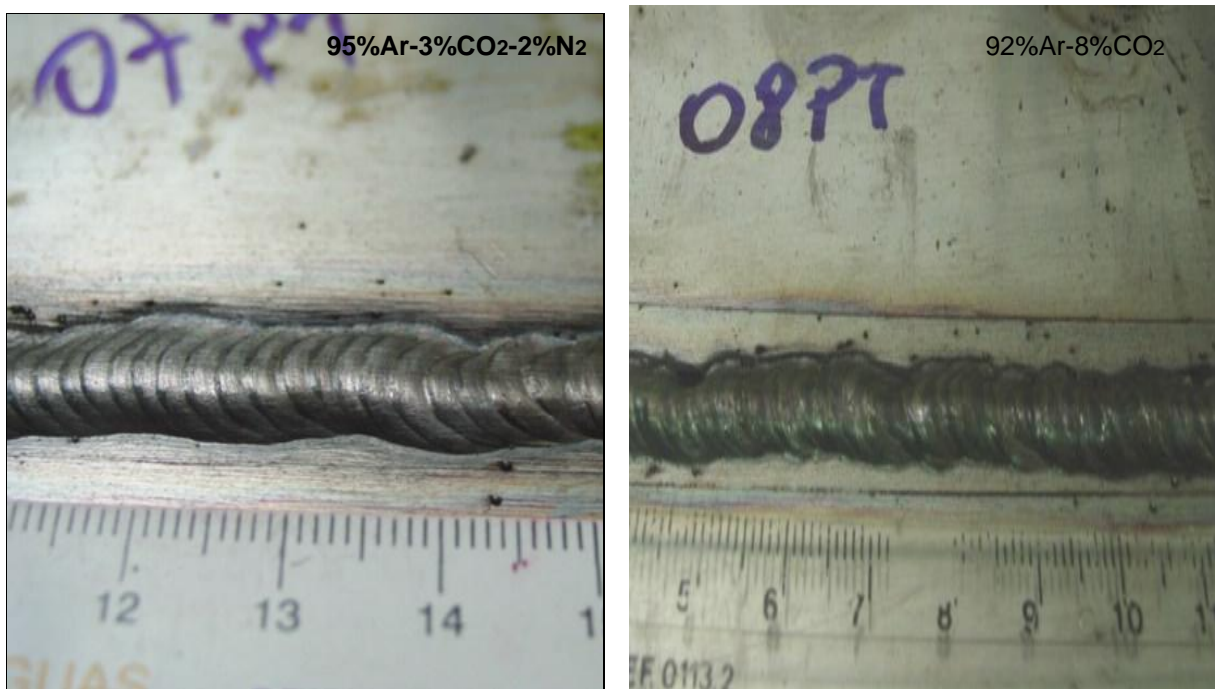
Figura 36 – Aspecto do cordão de solda – MAG-PT com comprimento do eletrodo de 10 mm
