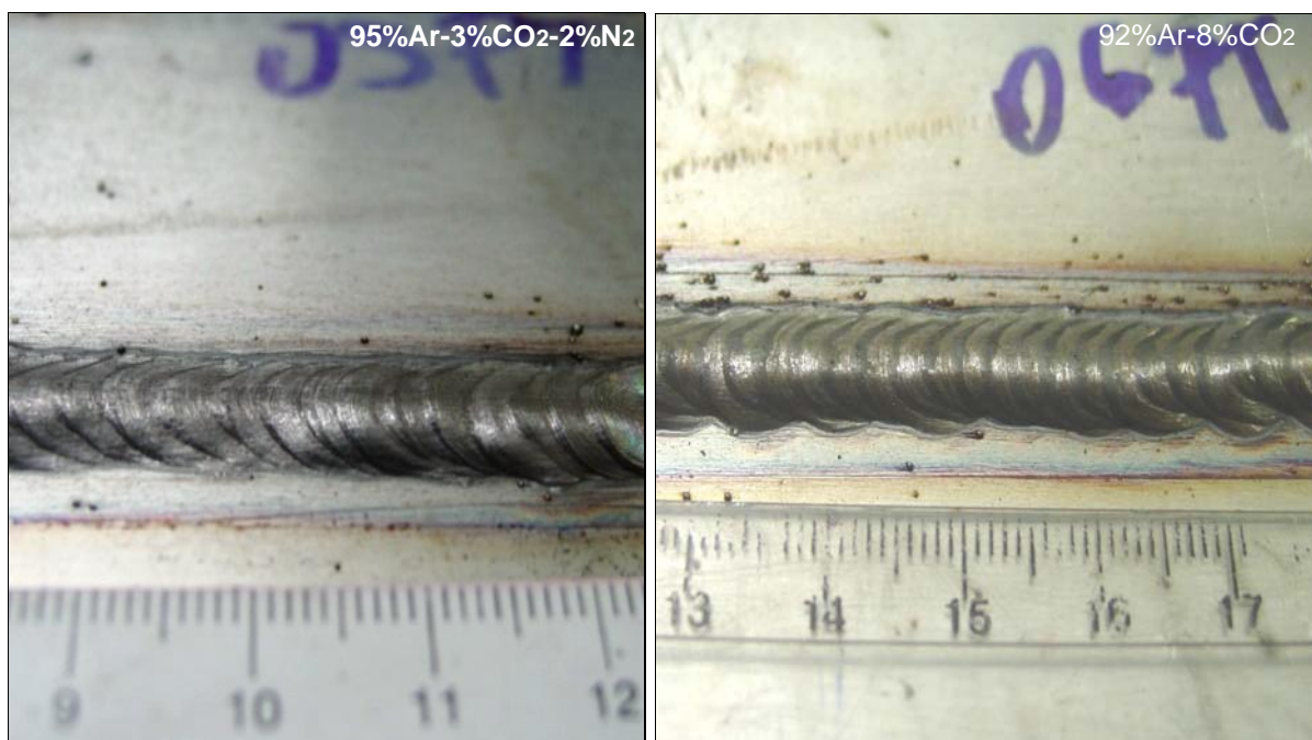
Figura 40 – Aspecto do cordão de solda – MAG-PT com comprimento do eletrodo de 20 mm
