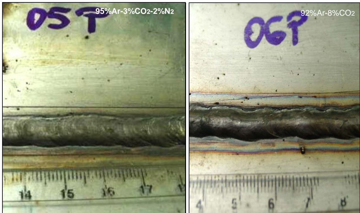
Figura 39 – Aspecto do cordão de solda –MAG-P com comprimento do eletrodo de 20 mm
