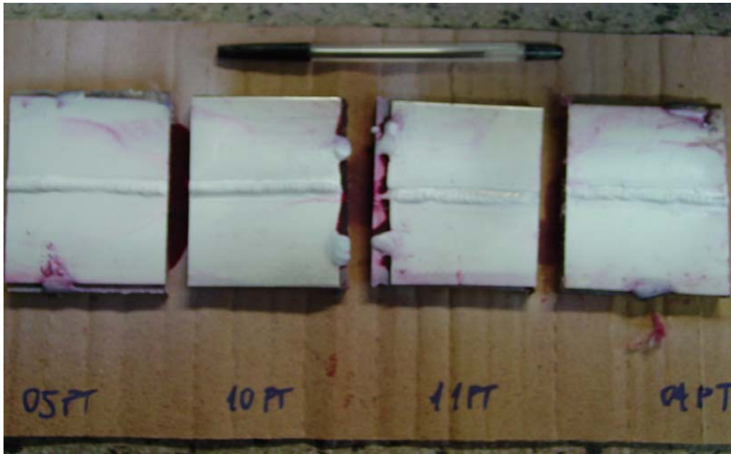
Figura 54 – Ausência de trincas e poros após ensaio por líquido penetrante para o MAG-PT
