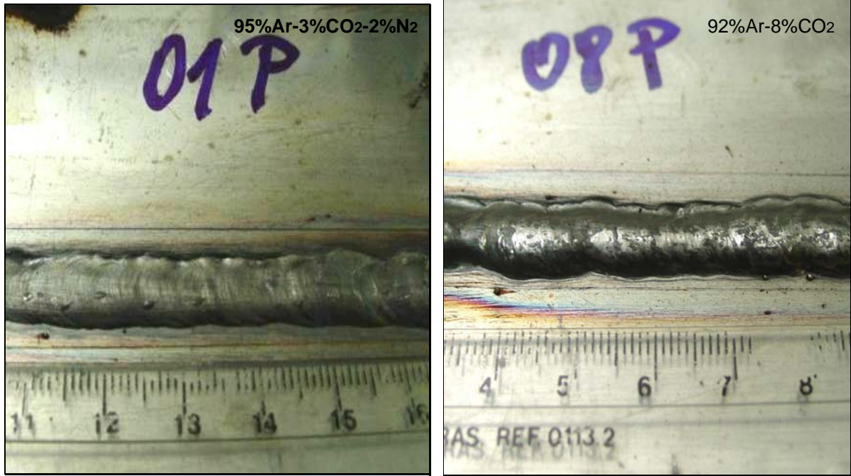
Figura 35 – Aspecto do cordão de solda MAG-P com comprimento do eletrodo de 10 mm
