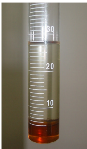
Figura 2.4. Separação das fases biodiesel de bociáúva (superior) e glicerina (inferior).
