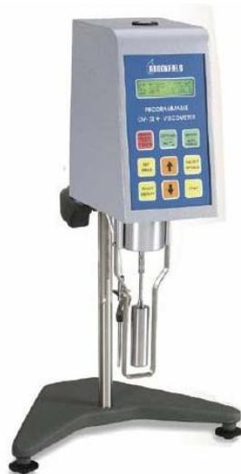
**Figura 6.** Viscosímetro Brookfield DVII
