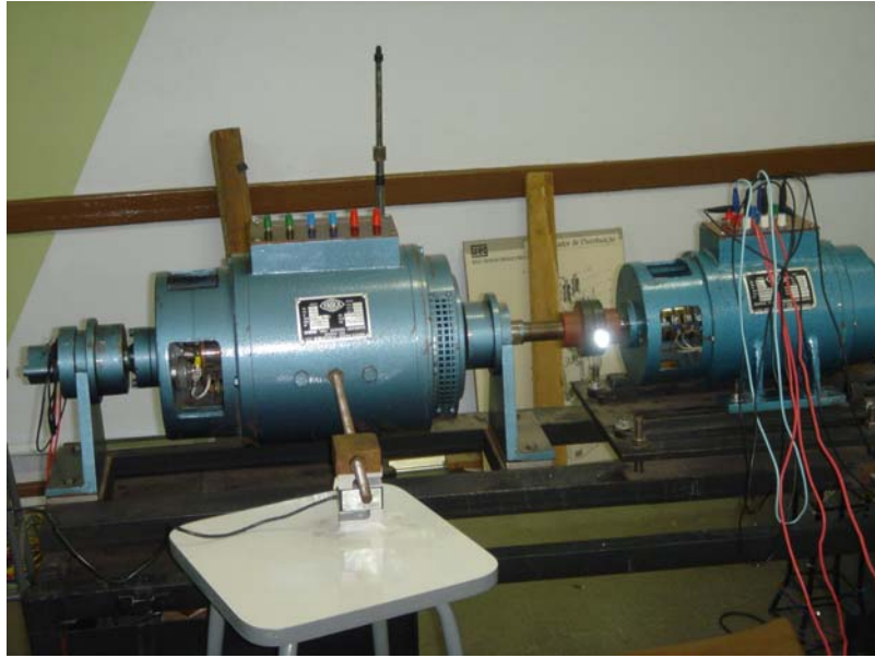
Figura 4.1: Arranjo de ensaio com freio eletrodinamométrico
